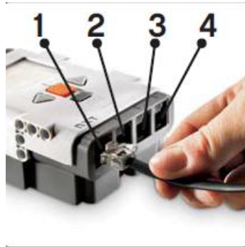
Şekil 8. Sensör ve Motorların NXT'ye Bağlanma Şekilleri
