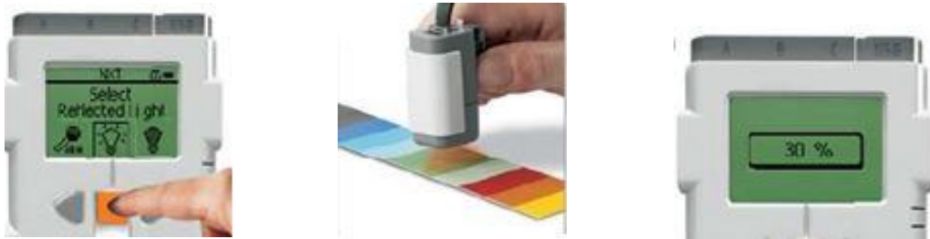
Şekil 9. Yüzeydeki ışığın yoğunluğunun ölçülmesi
