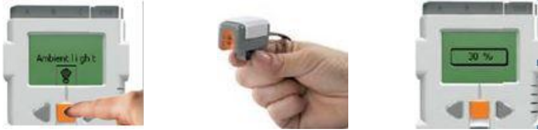
Şekil 11. Ortamdan sensöre gelen ışık yoğunluğunun okunması
