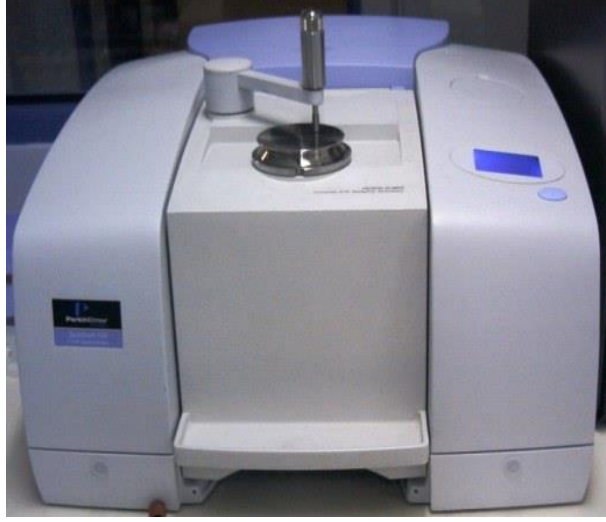
Şekil 3.9 ATR-FTIR Cihazı (Perkin Elmer, Spectrum 100)
