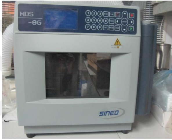
Şekil 3.1 Mikrodalga destekli ekstraksiyon cihazı
