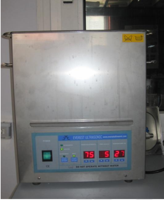
Şekil 3.2 Ultrasonik destekli ekstraksiyon cihazı
