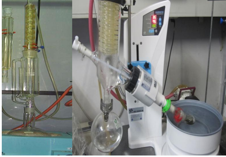
Şekil 3.3 Soksalet ekstraksiyon sistemi ve vakumlu evaporatör
