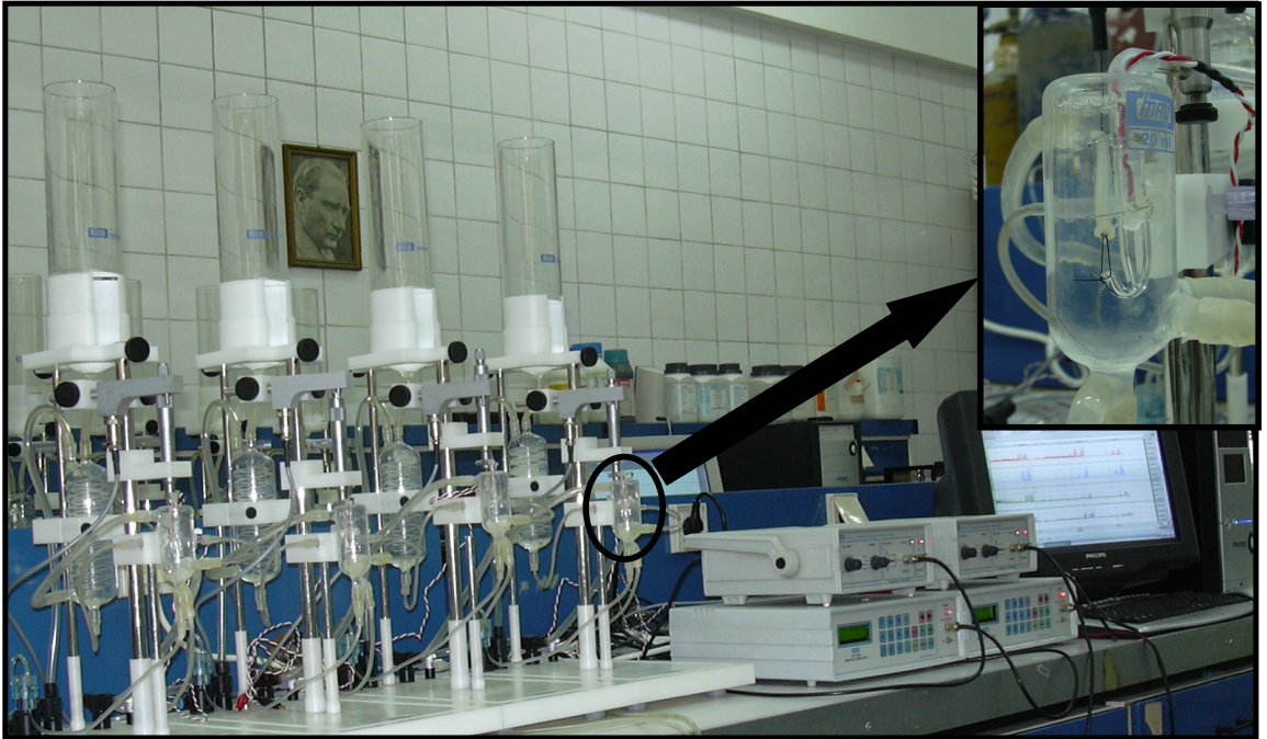
Şekil-7: Farmakolojik deneylerin yapıldığı tavşan izole kolon sirküler kas preparatlarının asılı olduğu dört kanallı organ banyosu (küçük resim), EAU oluşturmakta kullanılan stimülatörler ve izometrik "force displacement" transdüserlere bağlı, verileri analiz edebilme kapasitesine sahip bir yazılım kullanan, veri toplama sistemli çevrimiçi bilgisayar sistemi(MP35).
