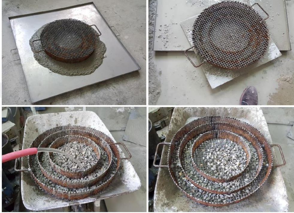
Şekil 3.9. 3 bölmeli elek testinin uygulama ayrıntıları
