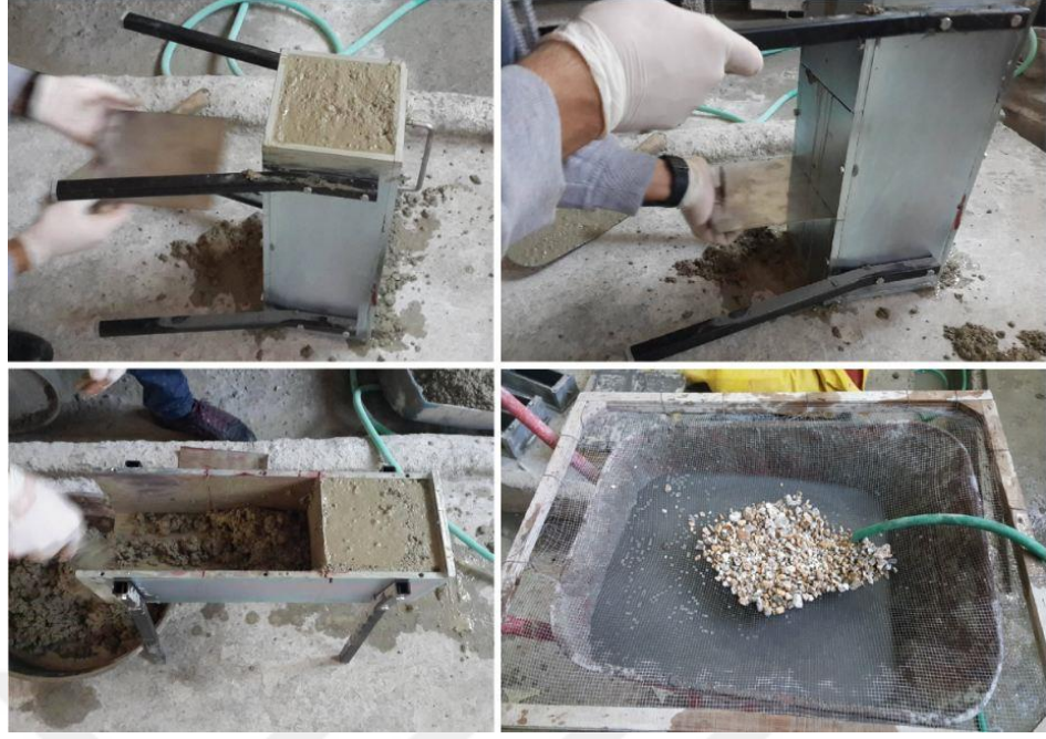
Şekil 3.8. Kolon segregasyon yönteminin uygulaması
