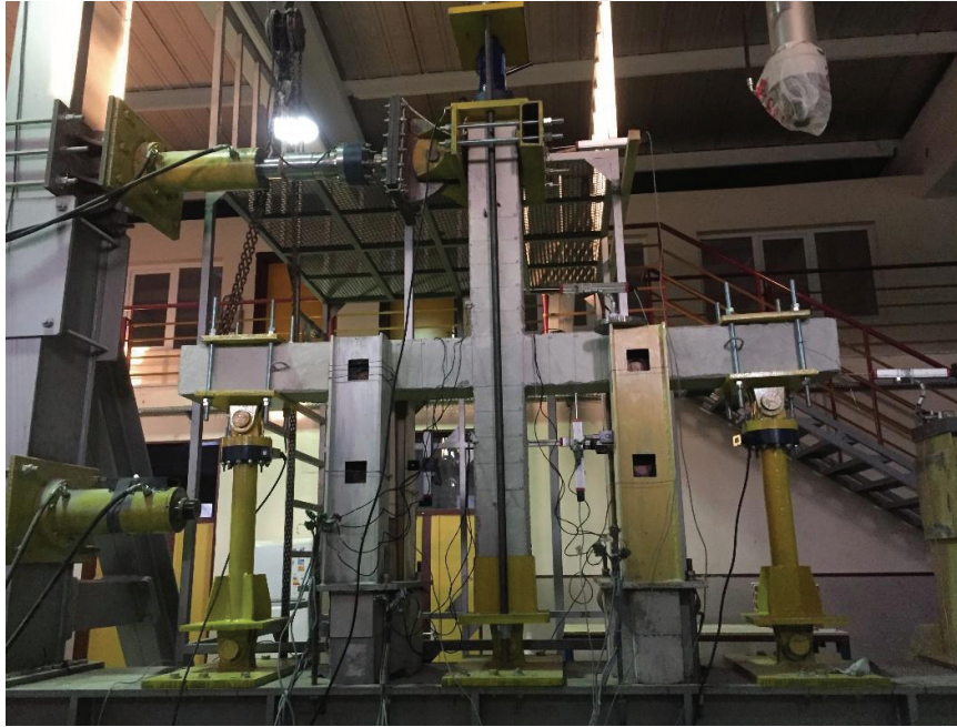
Şekil 5.25 Kompozit kolon – betonarme kiriş birleşim elemanı (F5)
