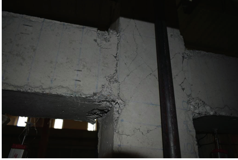
Şekil 5.12 Deney sonrası birleşim bölgesi hasar durumu (ön yüz) (F2)
