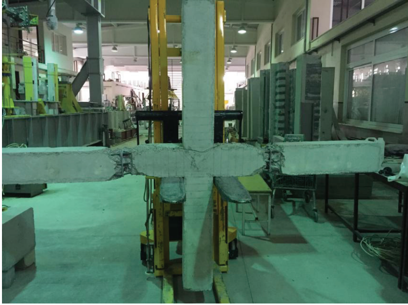
Şekil 5.20 Deney sonrası birleşim elemanında hasar durumu (F3)
