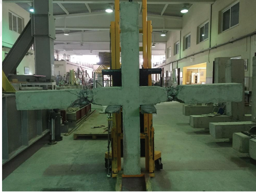
Şekil 5.24 Deney sonrası hasar durumu (F4)
