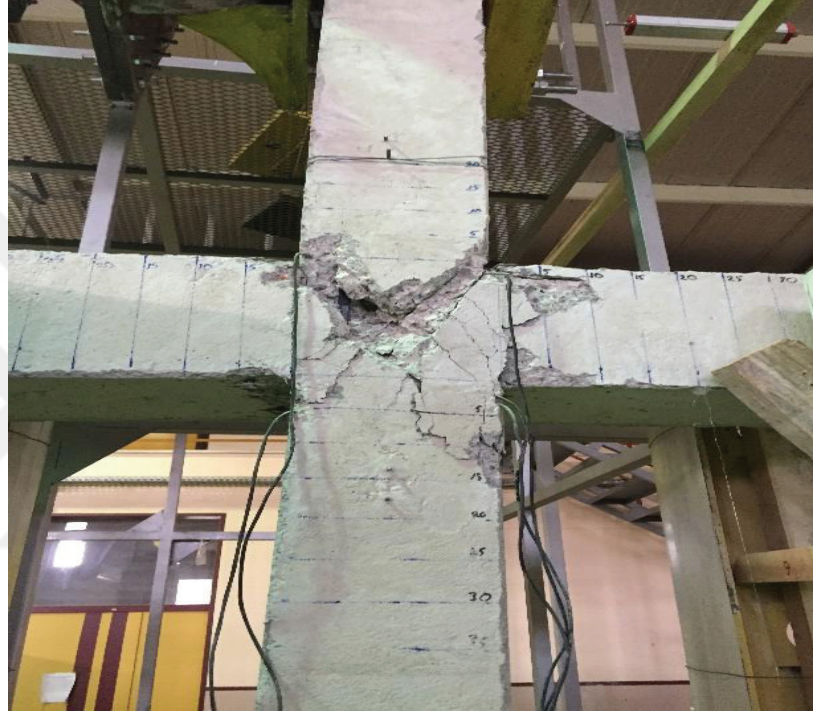
Şekil 5.6 Deney sonunda deney elemanı ön yüzünde meydana gelen hasar
