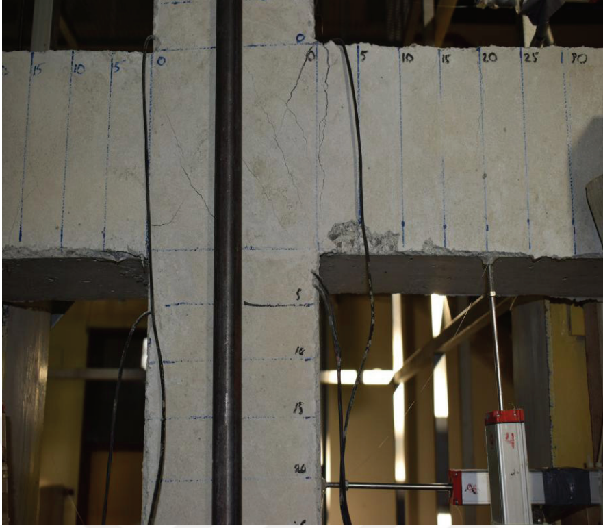
Şekil 5.5 Akma meydana geldiği anda deney elemanında oluşan hasar
