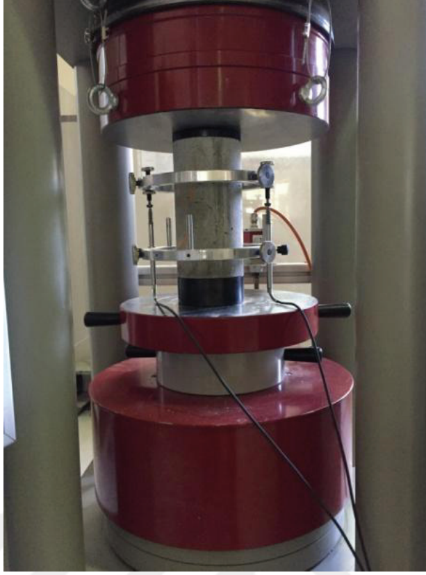
Şekil 3.2 Tek eksenli yükleme altında beton silindir numune
