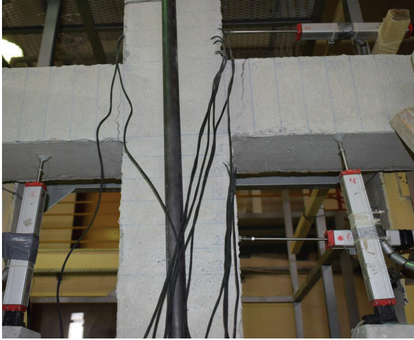
Şekil 5.11: Akma anında deney elemanında meydana gelen hasar (F2)
