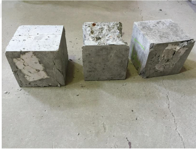
Şekil 3.1 Beton küp numuneler (basınç testi sonrası)
