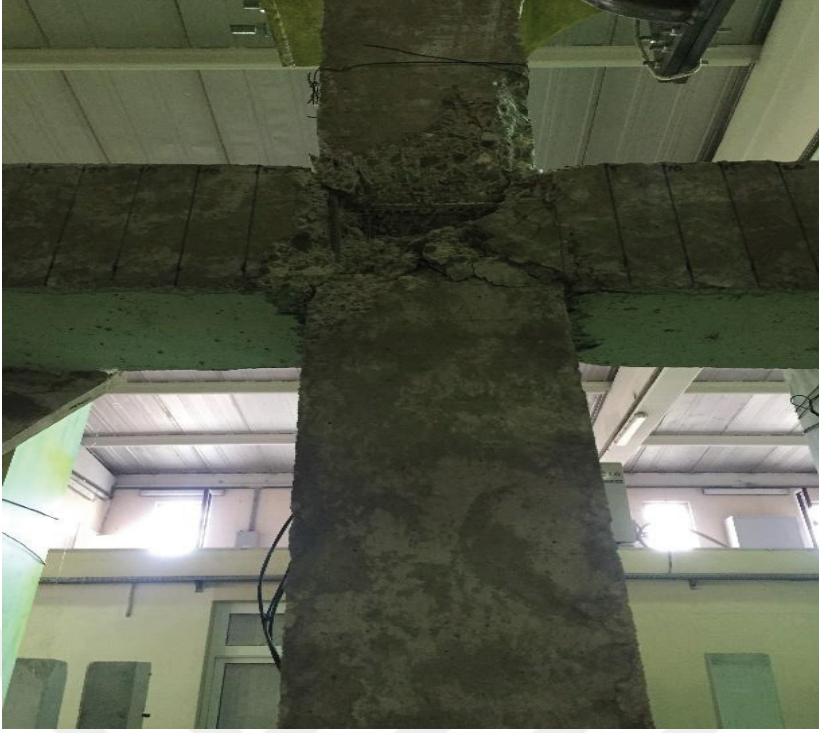
Şekil 5.7 Deney sonunda deney elemanı arka yüzünde meydana gelen hasar
