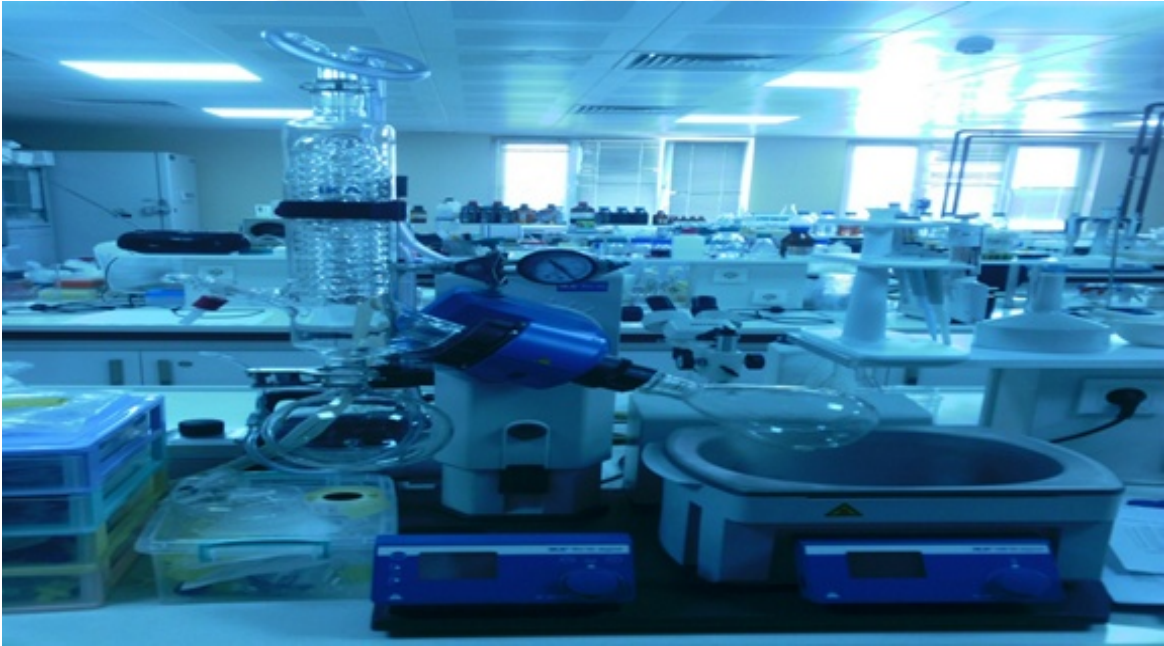
Resim 3.4. Bitki ekstraktlarındaki organik çözücünün uçurulmasında kullanılan Rotary evaporatör (Döner buharlaştırıcı)
