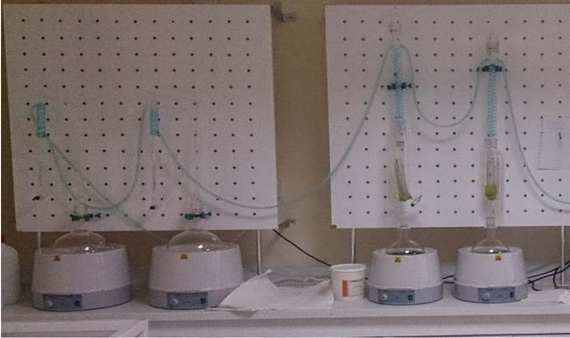
Resim 3.3. Bitki ekstraksiyonu için hazırlanmış Soklet düzeneği
