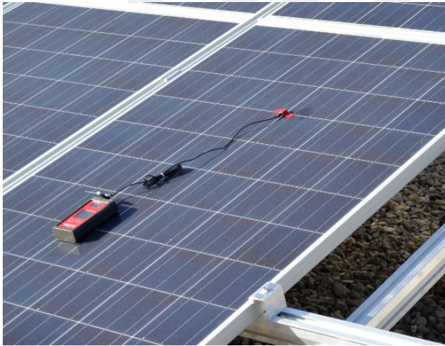
Şekil 3.16. Panel yüzey sıcaklığı ölçüm cihazı.
