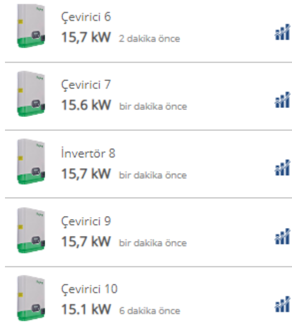
Şekil 4.9. Yüzey kirliliğinin olduğu durumda (temizlik öncesi) evirici çıkışları.
