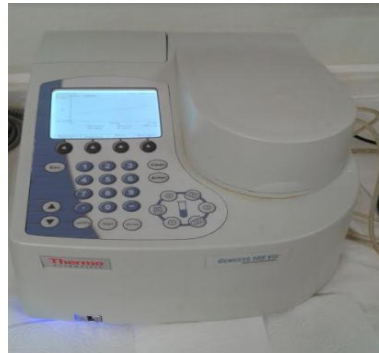
Şekil 3.3. PFO enzim aktivitesi ölçümünde kullanılan Thermo Scientific™ GENESYS™ 10S UV-Vis ısıtmalı spektrofotometre
