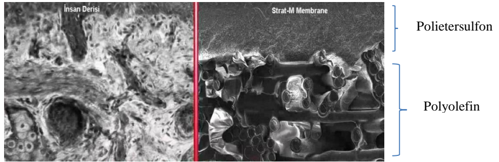
Şekil 3.4 Strat -M Membran yapısı.
