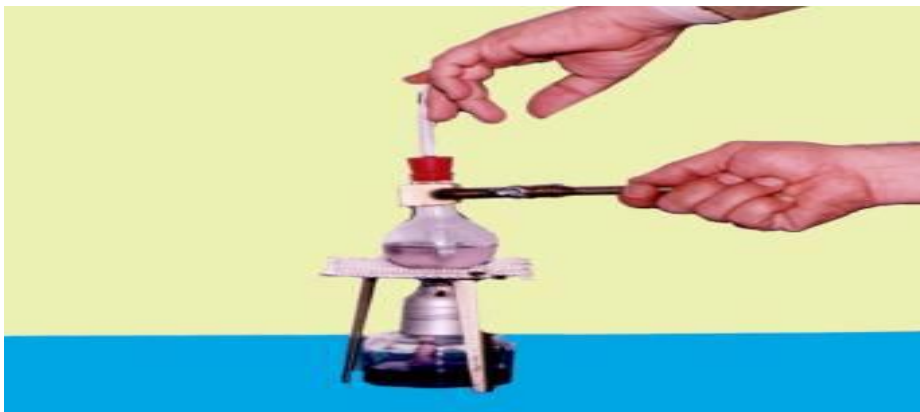
Resim 3. 1. Sıvılarda genleşme düzeneği
