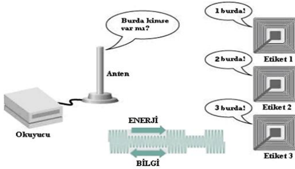
Resim 2.4. Basit bir RFID sistemi ve iletişimi [11]
