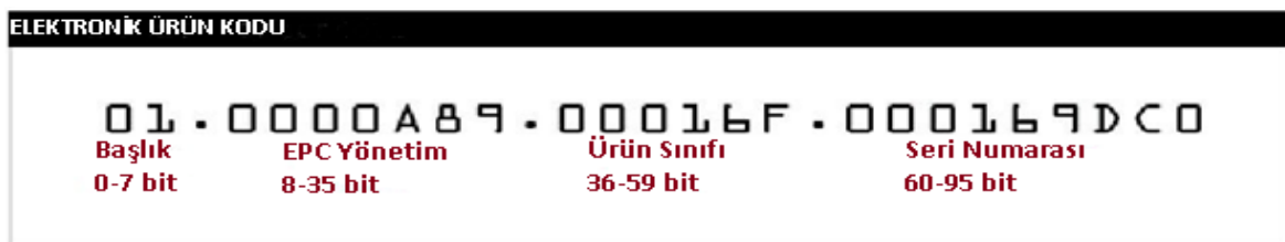
Resim 2.17. 96 bit uzunluktaki bir EPC'nin düzeni
