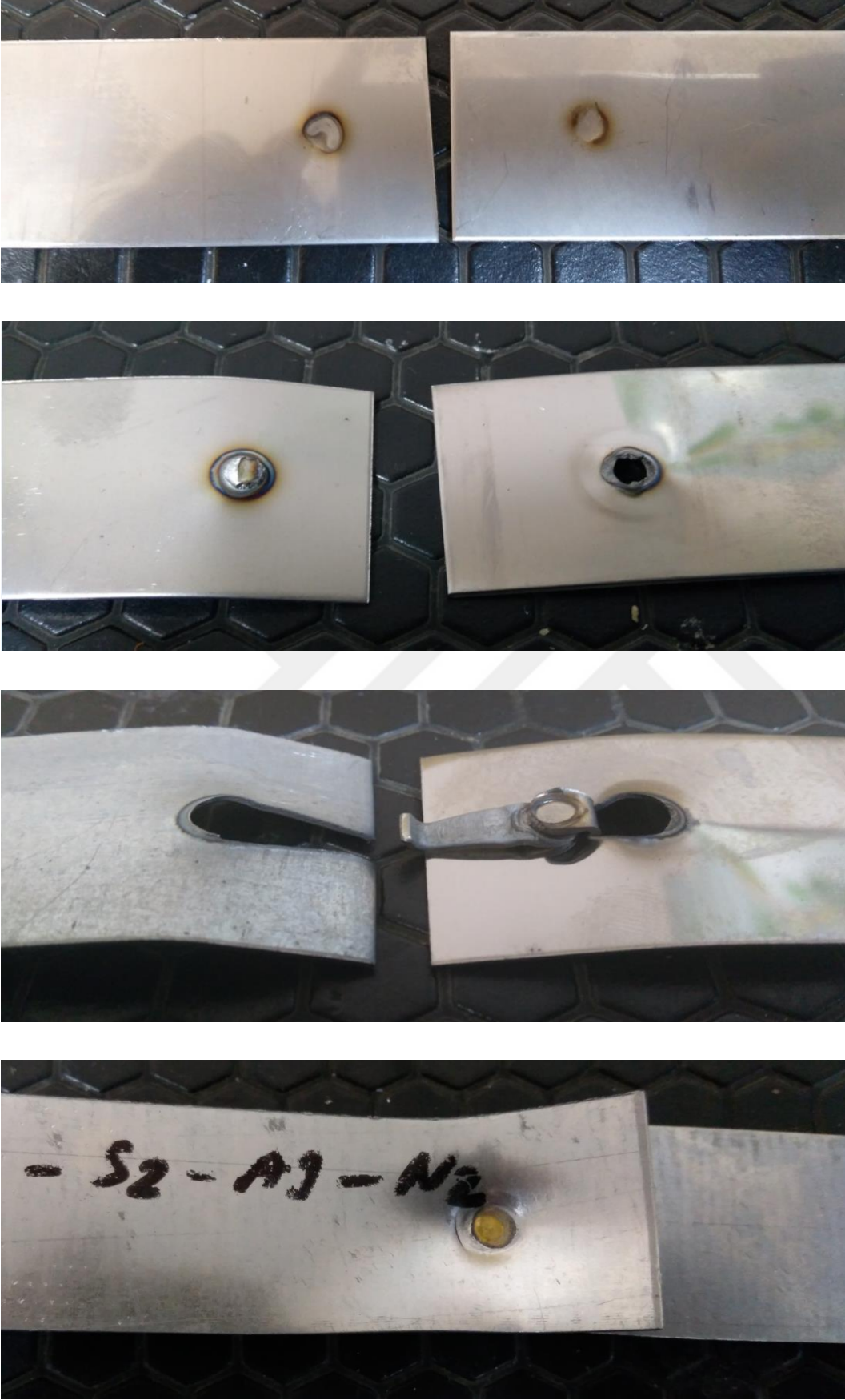
Şekil 4.6. Kopma türleri: a) Ayrılma kopması, b) Düğmeleme şeklinde kopma, c) Yırılma şeklinde kopma, d) Kaynak dikişiyile birlikte malzemenin yırtılması
