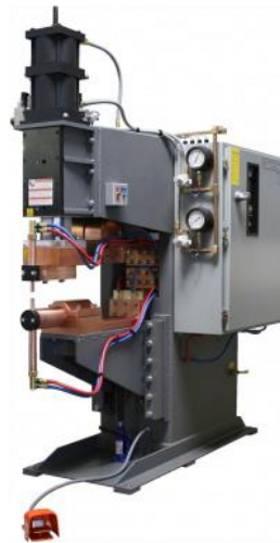
Şekil 2.1. Pres tipi nokta direnç kaynağı makinesi (Zpunta, 2018)
