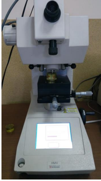
Şekil 4.7. Vickers sertlik deneyi düzeneği
