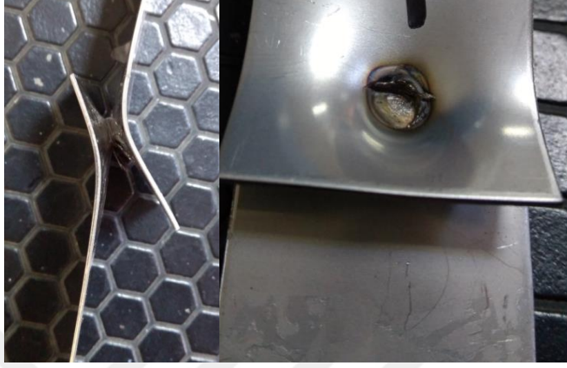
Şekil 5.8. 15-17 kA kaynak akım şiddetinde sac ara ve üst yüzeylerinde oluşan fişkirma
