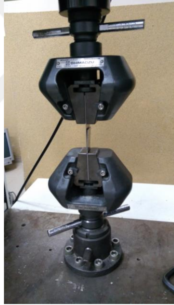
Şekil 4.5. Çekme-makaslama deney düzeneği
