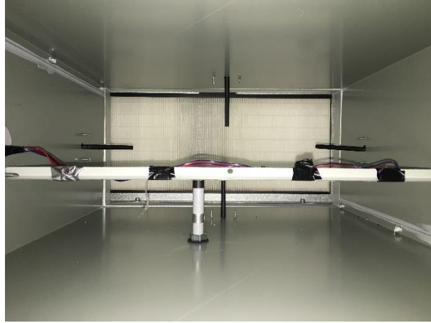
Şekil 5.24. Kanal içerisine yerleştirilmiş ısı çift düzlemi ve sıcaklık- nem sensörü
