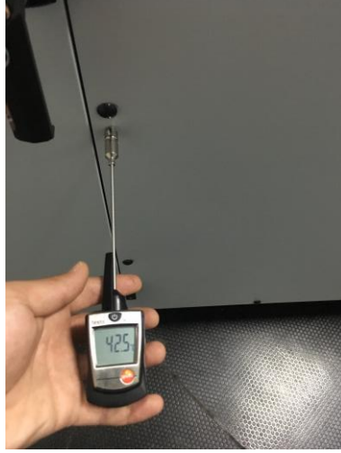
Şekil 5.29. Isıl köprüleme için en yüksek yüzey sıcaklığı ölçümü
