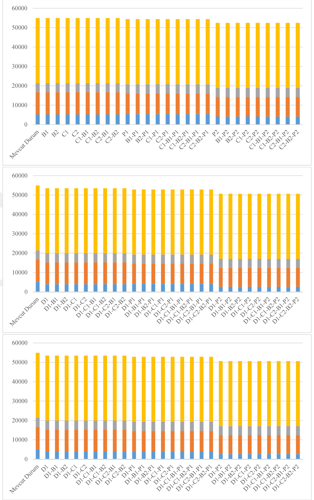
Şekil 4.23-Yapı kabuğunda alınan önlemlere ait senaryoların son kullanıcı tüketim değerleri a) D0 kombinasyonları b) D1 kombinasyonları c) D2 kombinasyonları.
