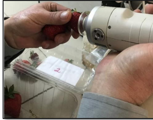
Şekil.3.24. Meyvelerde renk ölçümü.
