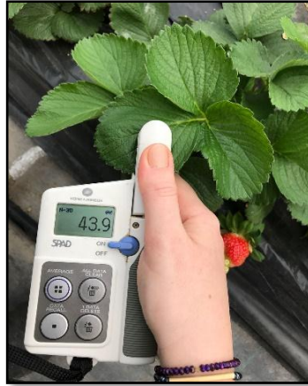
Şekil 3.19. Klorofil indeksi ölçümü.
