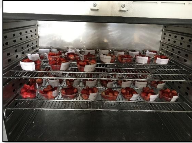
Şekil 3.28. Kuru ağırlık ölçümü.
