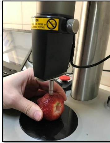
Şekil.3.26. Meyve eti sertliği ölçümü.
