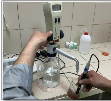
Şekil 3.30. Titreedilebilir asitlik (TA) ölçümü.
