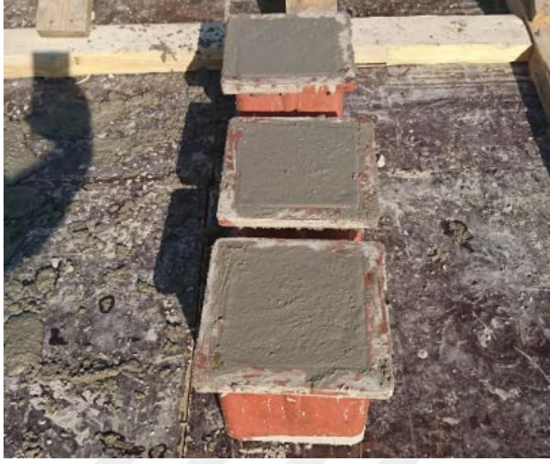
Şekil 3.14. Standart küp numunesi alımı
