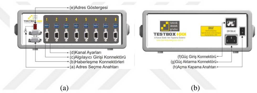
Şekil 3.20. Veri toplama sistemi (a) ön panel görünümü ve (b) arka panel görünümü
