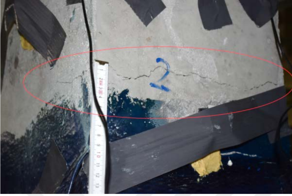
Şekil 4.36.CFRP bitiminde eğilme çatlağı oluşumu
