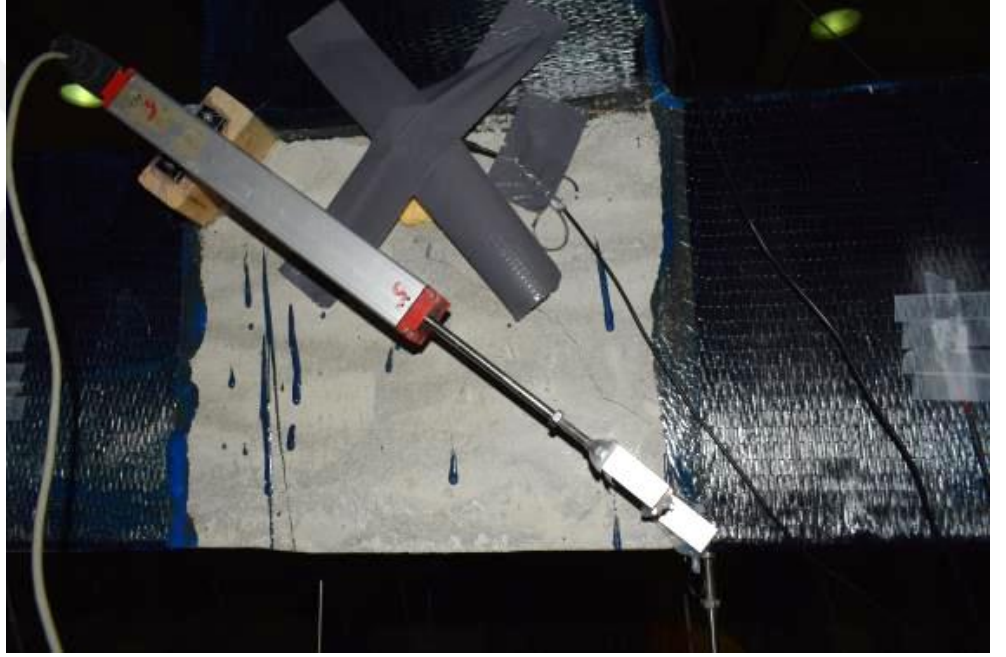
Şekil 4.122.Kolon pas payına doğru ilerleyen diyagonal çatlak görünümü
