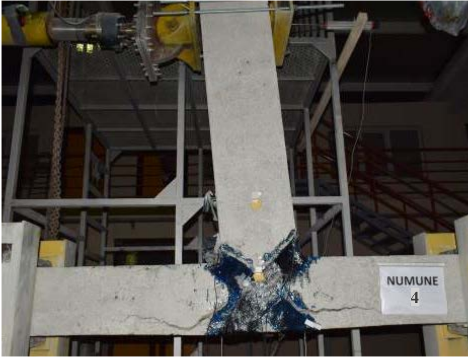
Şekil 4.56. Deney Elemanı-4 hasar durumu
