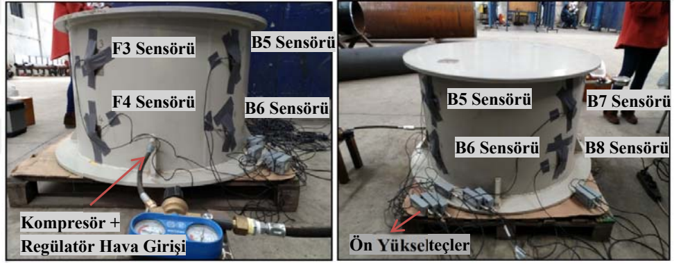
Şekil 3.16: Deney Elemanı-2 yüklem düzeni
