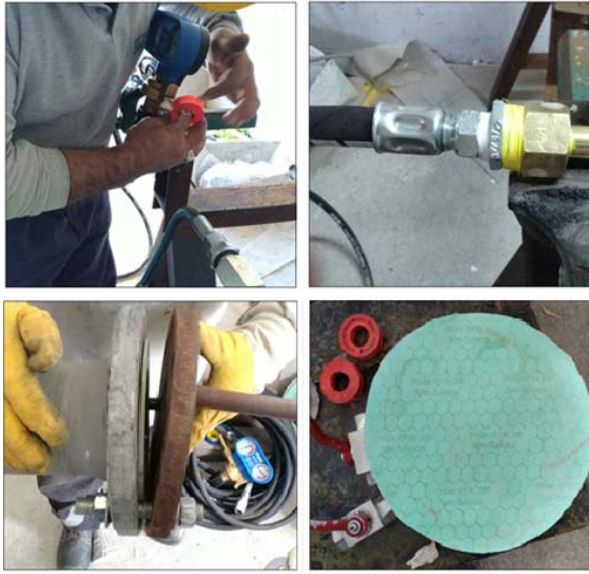
Şekil 3.10: Sızıntı önleyici contalar ve teflon bantlar
