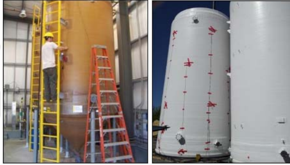
Şekil 2.10 FRP tanklarda sızıntının incelenmesi ( http://www.structuralinsights.com/SI/tank_inspection.php )
