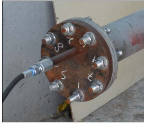
Şekil 3.11: Metrik 18 flanş birleşim civataları
