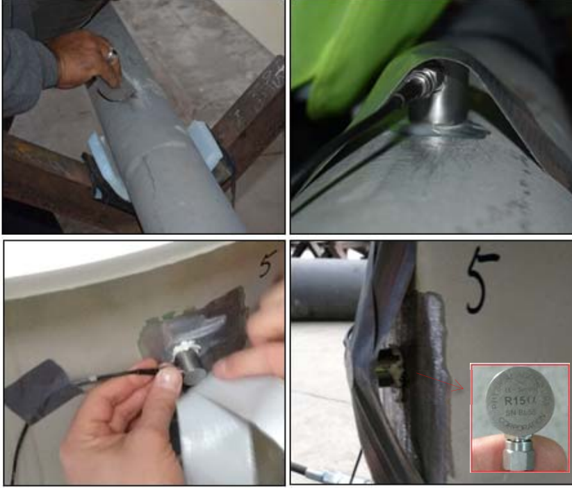
Şekil 3.13: Strafor kullanımı ve AE sensörlerinin montajı
