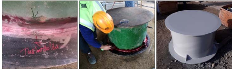
Şekil 3.5: Deney Elemanı-2'nin kaynaklarının penetrant testi ile kontrolü ve deneye hazır hale getirilmesi
