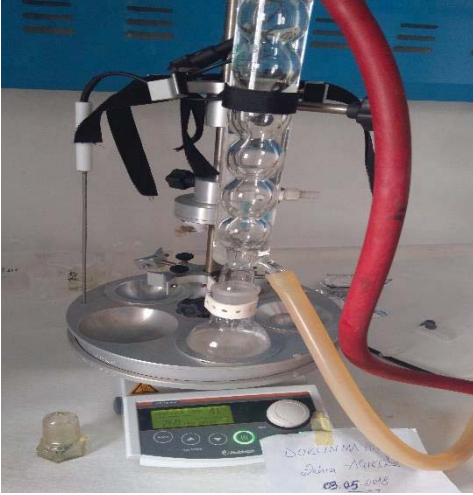
Şekil 3.27: Geri soğutma işlemi
