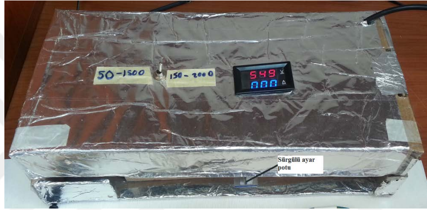
Şekil 3.13 Tez kapsamında geliştirilen Yüksek gerilim kaynağı
