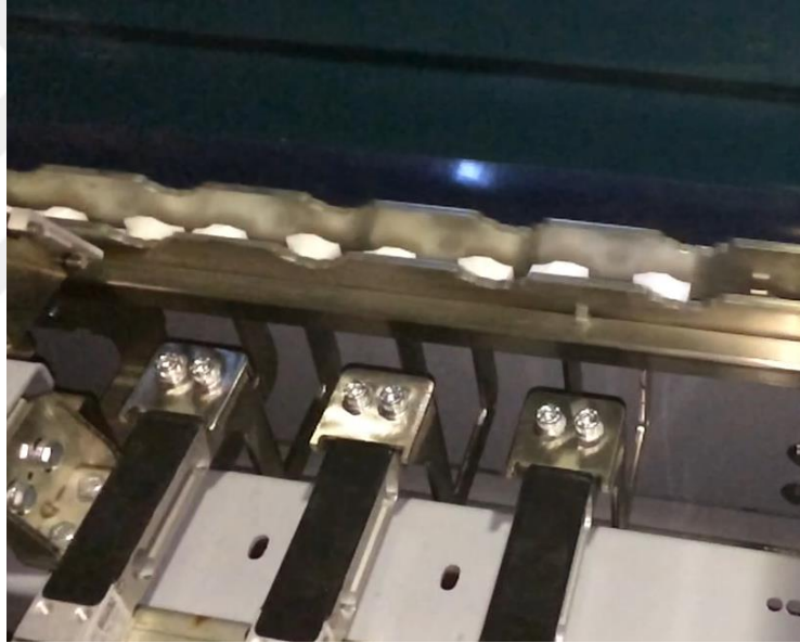
Fotoğraf 3.4: Taşıyıcının Üst Ölü Noktası
