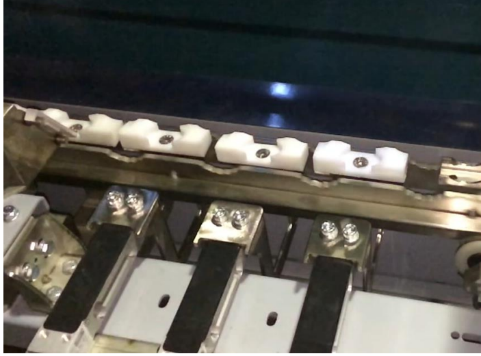
Fotoğraf 3.3: Taşıyıcının Alt Ölü Noktası, Ölçüme Başlama Noktası
