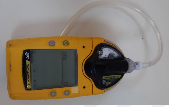
Şekil 3.4. Ambalaj içi kükürt dioksit konsantrasyonu ölçen cihaz.
