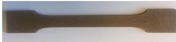
Şekil 5.5 Enjeksiyon üretimi çekme çubuğu (ISO EN 527, 1A)
