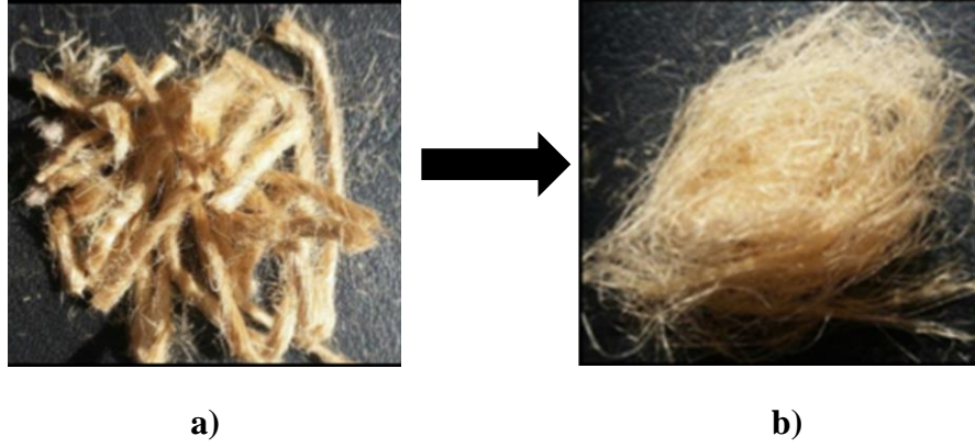
Şekil 4.2 a) 15-18 mm jüt iplikler, b) Hava basıncına maruz kalmış jüt lifleri
