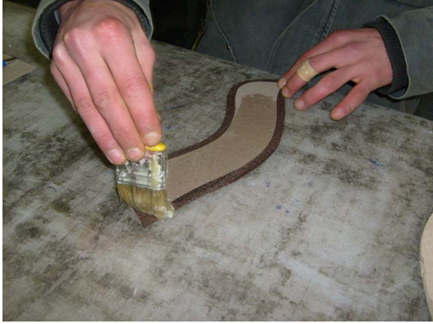
Şekil 41: Pervazın Tersinden Yapıştırıcının Sürülmesi
