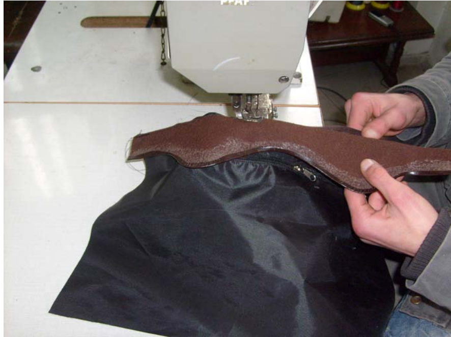
Şekil 55: Astarın Pervazla Birleştirilmesi
