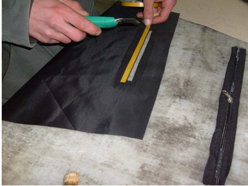
Şekil 51: Çift Taraflı Bantın Yerleştirilmesi
