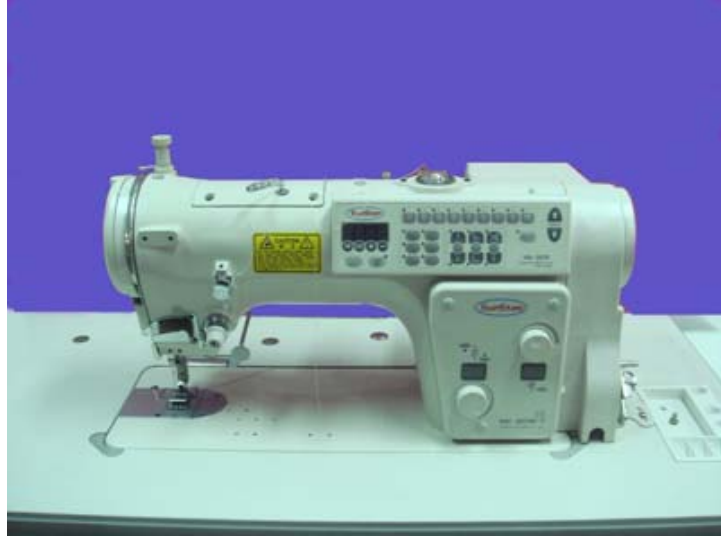
Şekil 16: Deri Dikiş Makinesi
