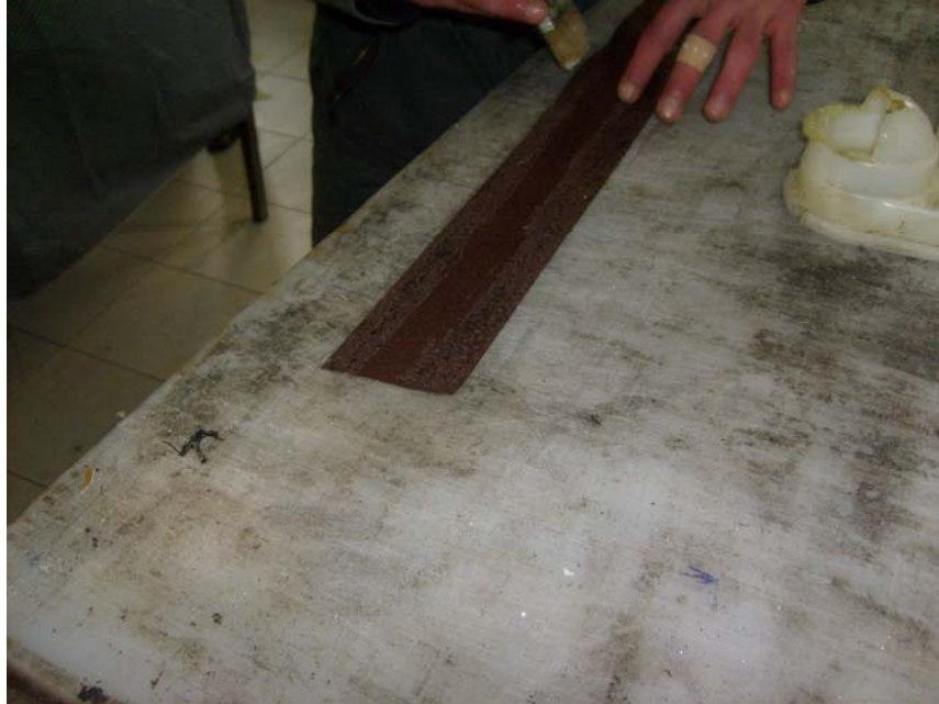
Şekil 59: Sap Kısımlarına Yapıştırıcı Sürülmesi
