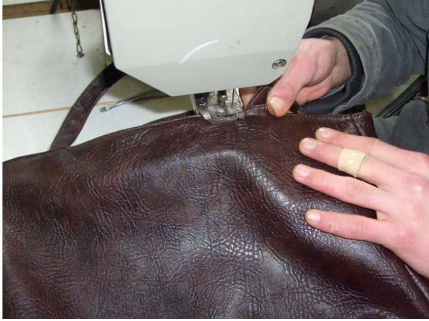
Şekil 62: Sapların Çanta İle Birleştirilmesi
