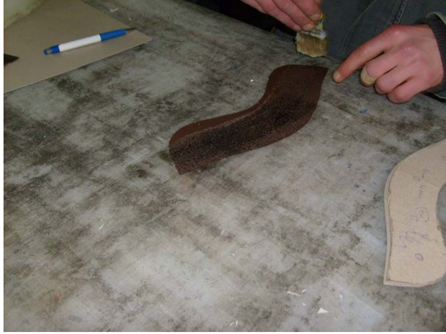
Şekil 38: Derinin Tersine Yapıştırıcı Sürülmesi
