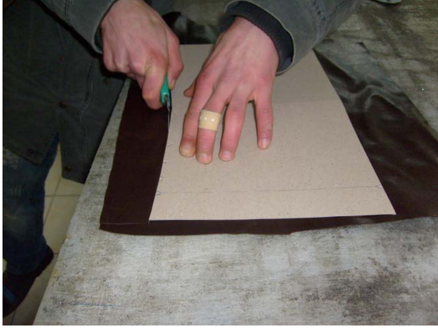
Şekil: 36: Çıkarılan Kalıbın Deriye Uygulanması
