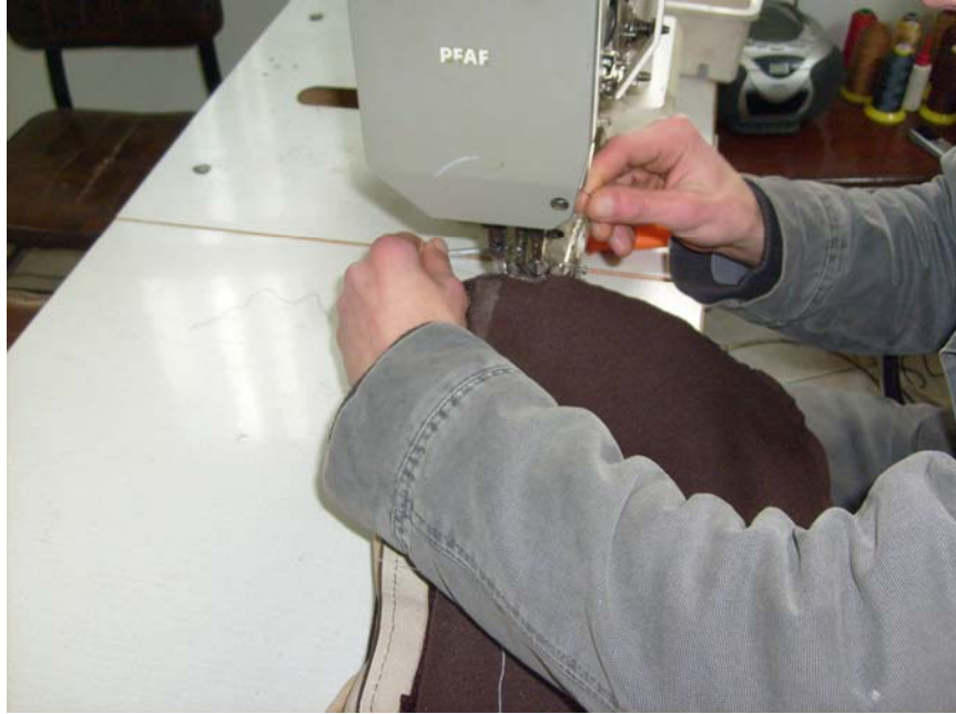
Şekil 57: Çantanın Parçalarının Birleştirilmesi
