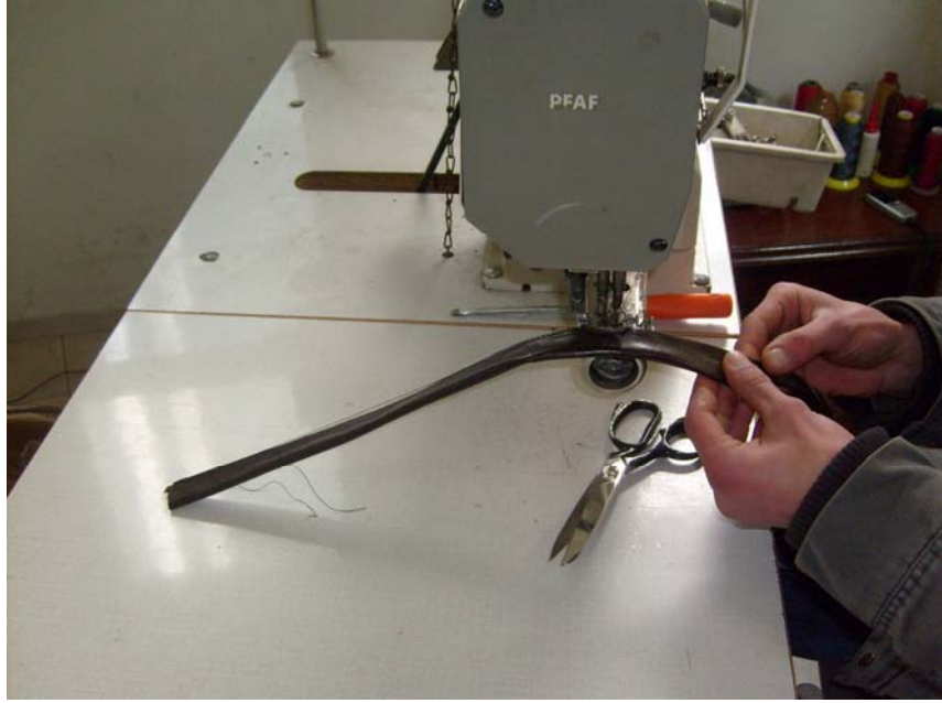
Şekil 61: Sap Parçasının Makine ile Dikilmesi
