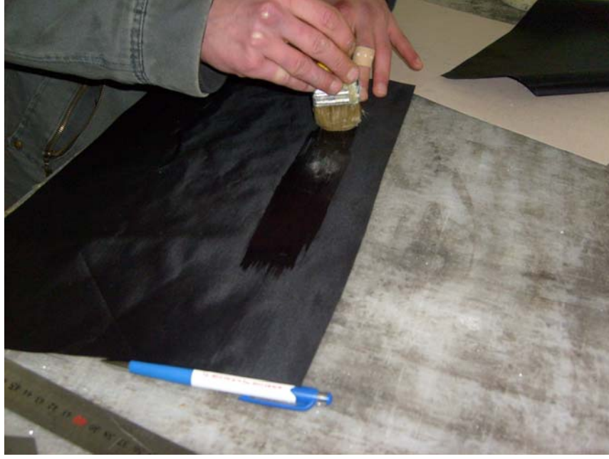
Şekil 50: Cep Yerine Yapıştırıcı Sürülmesi
