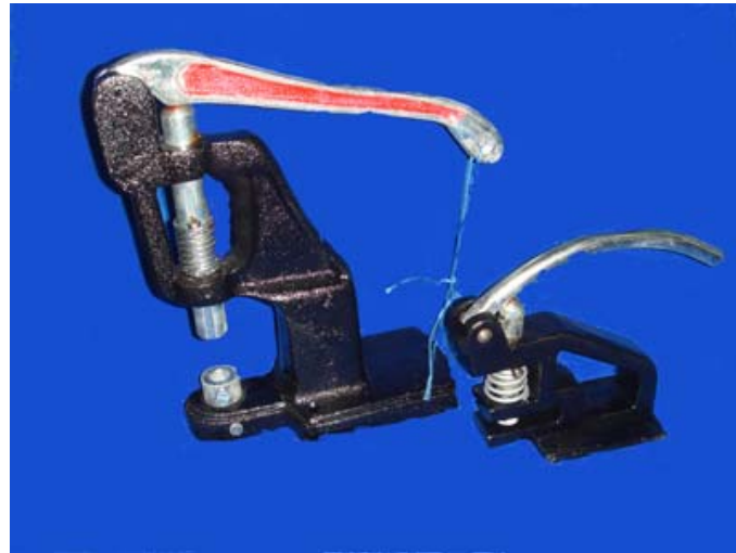
Şekil 20: Fermajup, Zımba(açık, kapalı) Basma Aleti
