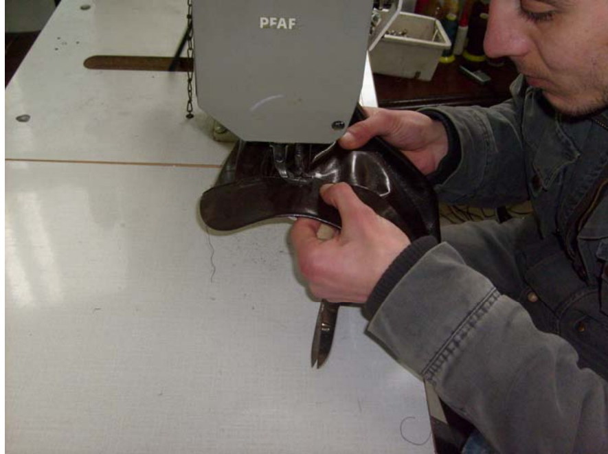
Şekil 44: Pervaz ve Ana Parçanın Birleştirilmesi
