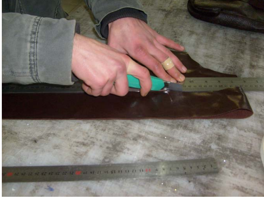
Şekil 58 : Çanta Sapının Kesilmesi
