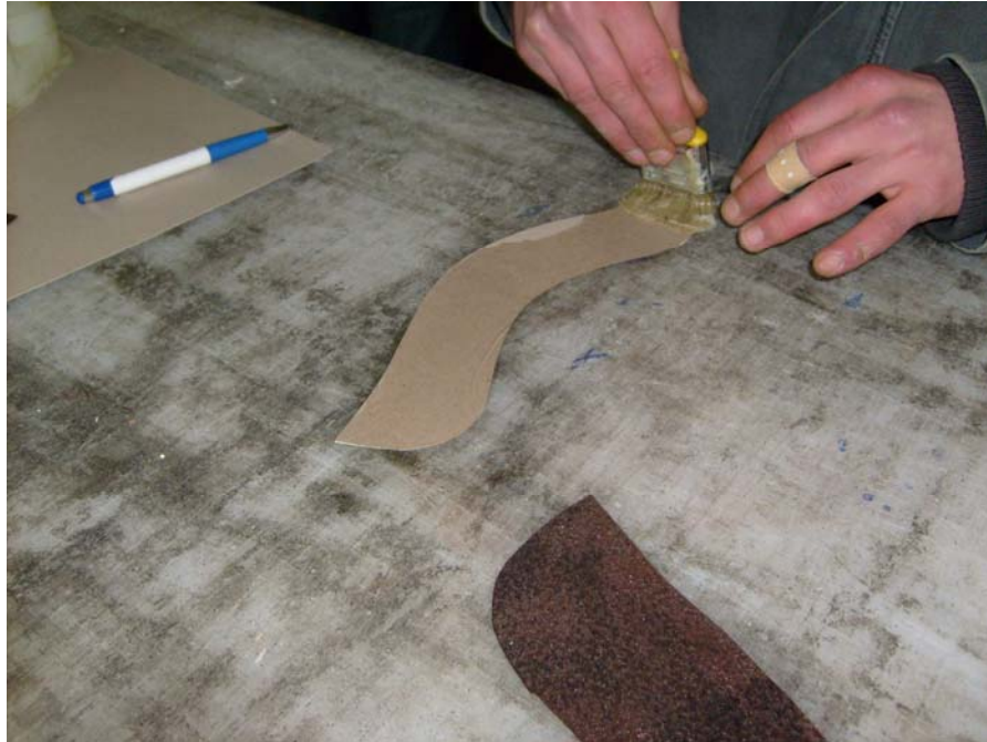
Şekil 39: Mukavvaya Yapıştırıcının Sürülmesi
