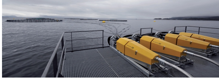
Şekil 2.2.3. Hava basınçlı, bilgisayar kontrollü yemleme üniteleri
