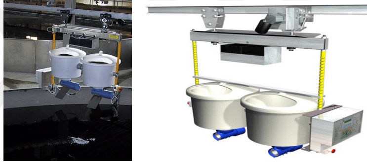
Şekil 2.2.2. Kuluçkahanelerde Kullanılan Yem Verme Robotu
