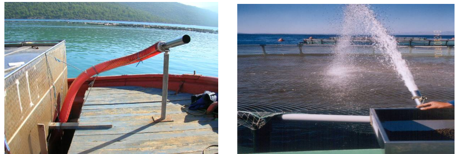
Şekil 4.2.2. Pnömatik (hava) ve Su ile Yemleri Atan Sistemler
