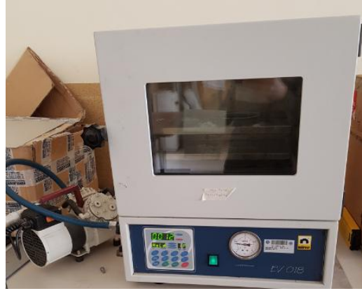
Şekil 3.2. NUVE EV 018 vakumlu etüv
