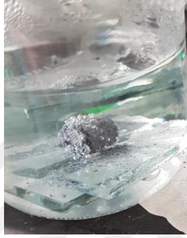
Şekil 4.7. Daldırma testi \text{H}_2 gazı nedeniyle oluşan baloncuklar
