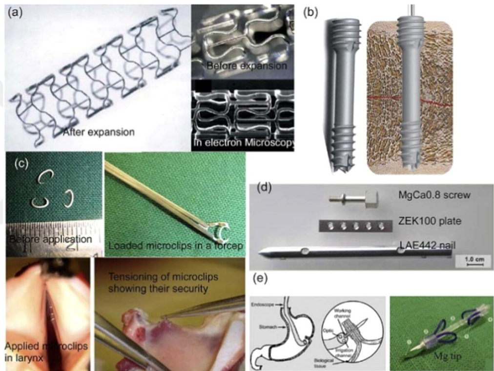
Şekil 2.16. Biyobozunur magnezyum implantların gerçek / olası uygulamaları: a) kardiyovasküler stent (BIOTRONIC, Berlin, Almanya, klinik deneme aşamasında), b)MAGNEZIX vida ( Avrupa'da CE işareti aldı), c) Gırtlak mikrocerrahisi için mikroklipsler (saf magnezyum), d) Biyobozunur ortopedik implantlar, e) Yara kapama cihazları (WZ21) (Chen et al., 2014).
