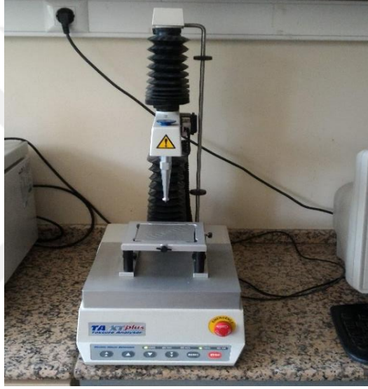
Şekil 3.20 TA-XT plus tekstür analiz (Stable Micro Systems Ltd., Surrey, UK) cihazı
