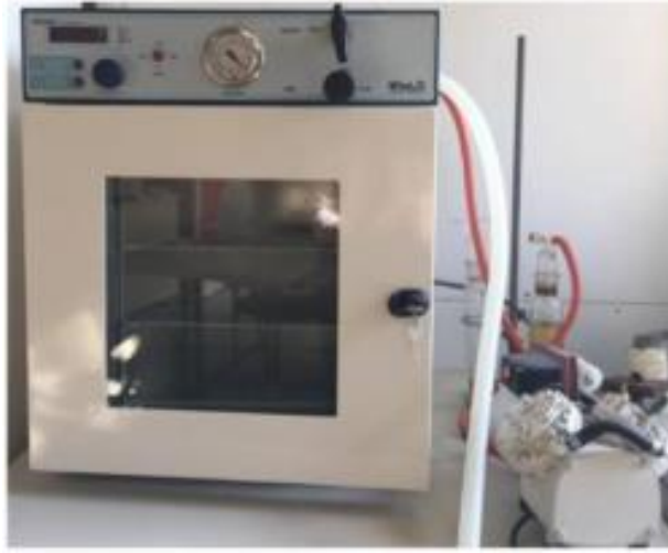
Şekil 3.10 Analizlerde kullanılan vakumlu etüv (WiseVen WOW-30 (Almanya))
