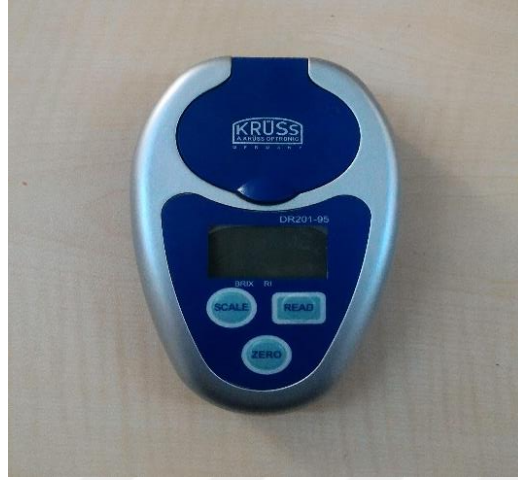
Şekil 3.12 Suda çözünür kuru madde analizinde kullanılan refraktometre (Krüss (Almanya))
