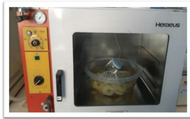
Şekil 3.7 Vakumlu emdirim işleminin gerçekleştirildiği vakum etüv
