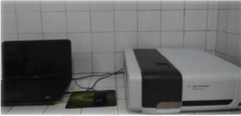
Şekil 3.17 Agilent Technologies Cary 60 UV-VIS Spektrofotometresi (ABD)
