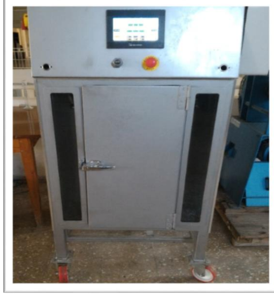
Şekil 3.9 Armutların kurutulması için kullanılan laboratuvar tipi tepsili kurutucu
