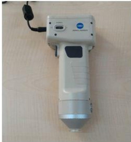
Şekil 3.16 Konica minolta CR-400 (Japonya) model kolorimetre
