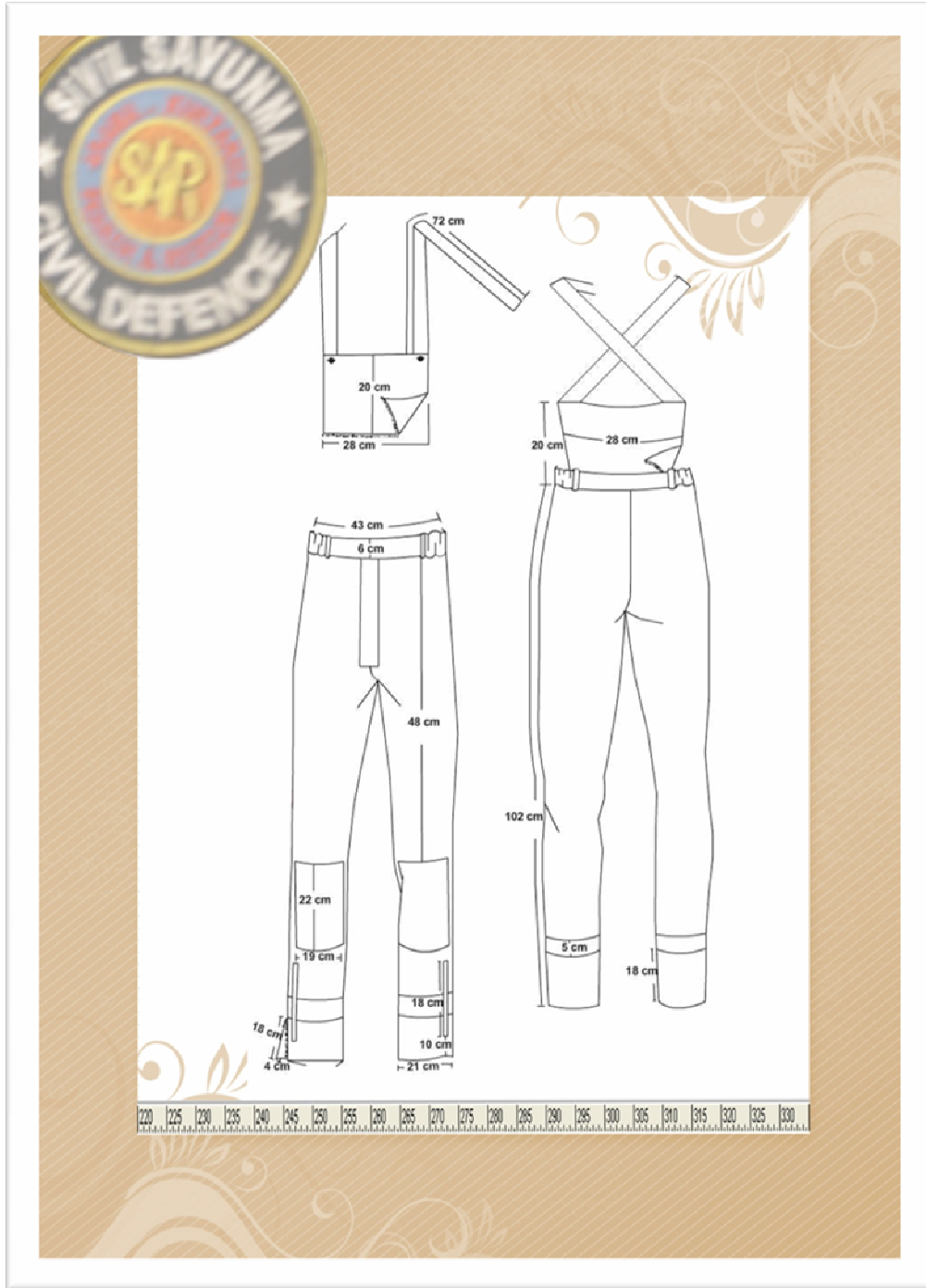
Resim 25. Son Model – Dış Yüzü (Pantolon Teknik Çizim)
