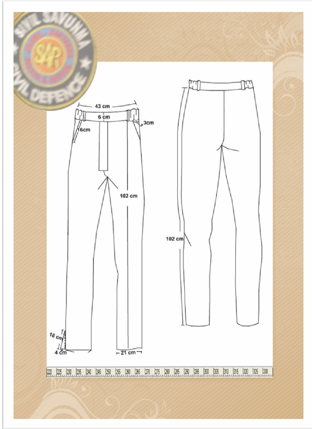
Resim 30. Son Model - İç Yüzü (Pantolon Teknik Çizim)
