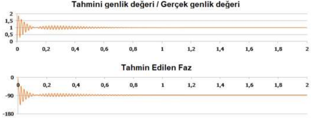
Şekil 2.22 \omega_0=7.8125\text{rad} ( f_0 \approx 1.24\text{Hz} ), f_{\text{giriş}}=50\text{Hz} iken kalıcı hal hatası
