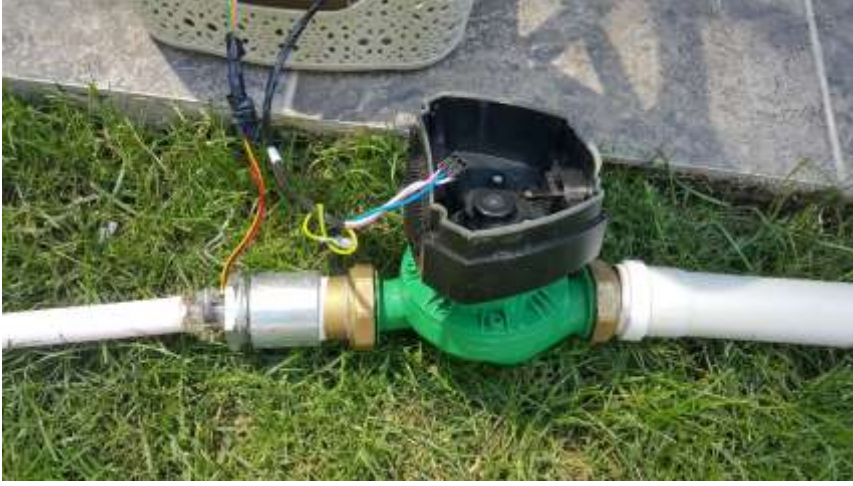
Şekil 6.3 GPA32-8 IV model pompa ile YF_S201C tip debiölçer
