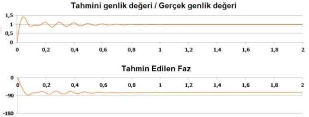
Şekil 2.23 \omega_0=7.8125\text{rad} ( f_0 \approx 1.24\text{Hz} ), f_{\text{giriş}}=10\text{Hz} iken kalıcı hal hatası (Motor Control with RX62T, 2011)
