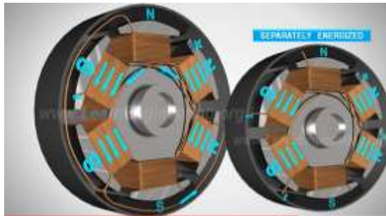
Şekil 2.11 Ayrık uyarılmalı yerine önerilen tek uyarımlı sargı şekli
