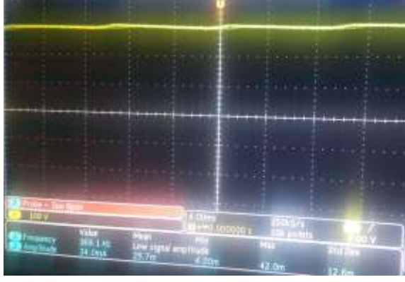
Şekil 6.12 Yüksek toklarda bus voltajı dalgalanması
