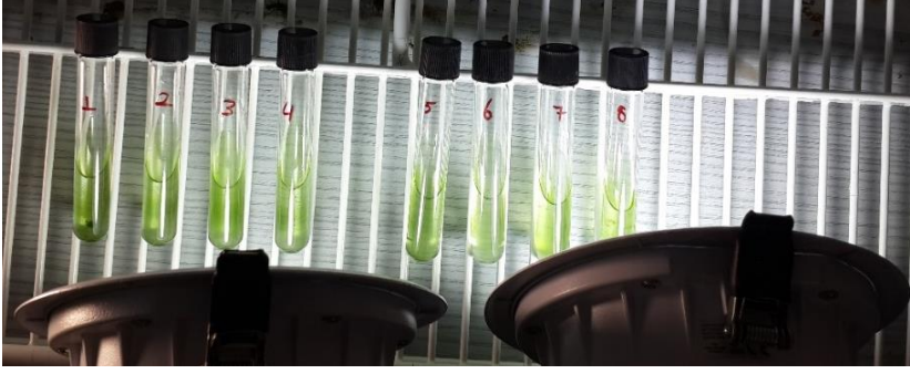
Şekil 3.10 Deney tüplerinde besin stresi 2.deneme (t 0 anı): 1.tüp kontrol Bold INV, 2.tüp vitaminsiz Bold INV, 3.tüp %50 su %50 Bold INV, 4.tüp %90 su %10 Bold INV, 5.tüp %1 NaCl içeren Bold INV, 6.tüp %0.5 NaCl içeren Bold INV, 7.tüp %1 NaCl içeren vitaminsiz Bold INV, 8.tüp %0.5 NaCl içeren vitaminsiz Bold INV.
