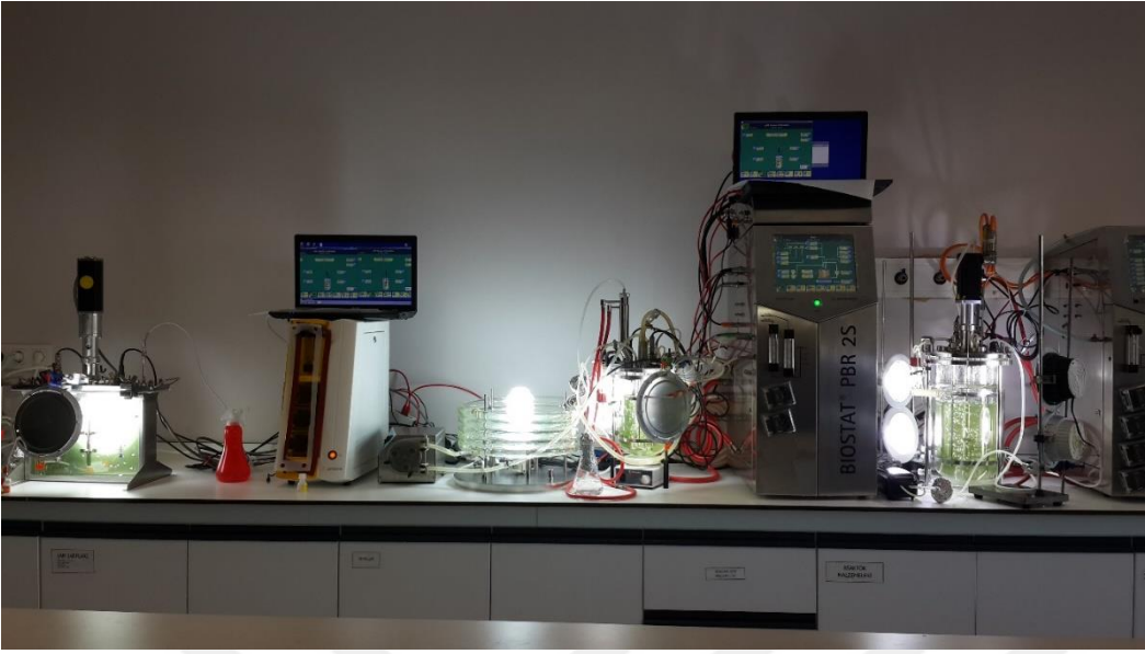
Şekil 3.7 Farklı fotobiyoreaktörlerde C. nivalis 'in üretimi. Soldan sağa doğru: Panel, Tübüler, KT FBR
