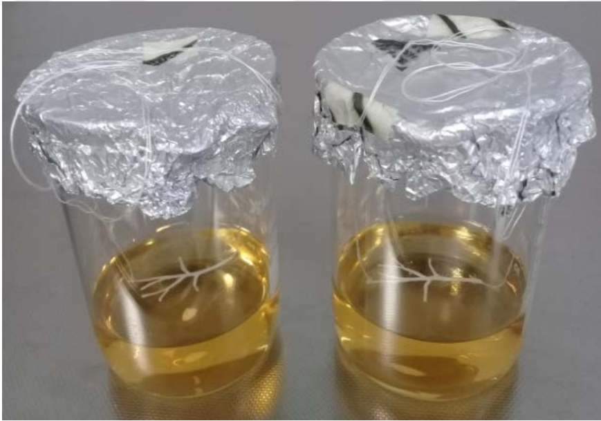
Şekil 3.5: 3B PLA kalıpların, inokulumu yapılan HS besin ortamına steril koşullarda yerleştirilmesinin görüntüsü
