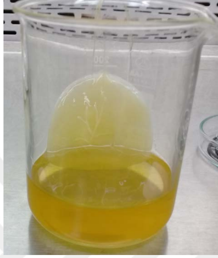
Şekil 4.5: Gevşek selüloz nanofiberler temizlenmeden yapılan üretim sonrası iki katmanlı üretim
