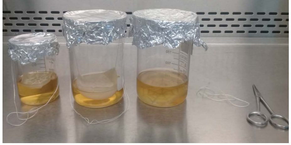
Şekil 4.3: In situ BS/PLA biyokompozitin üretim sürecinde BS/PLA biyokompozitin ters çevirme işlemin görüntüsü
