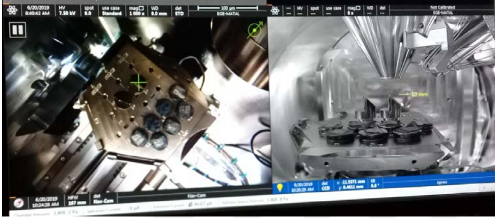
Şekil 3.7: 1 cm 2 kare boyutlarında BS'den alınan örnekler SEM analizi için SEM cihazına yerleştirilmesinin görüntüsü
