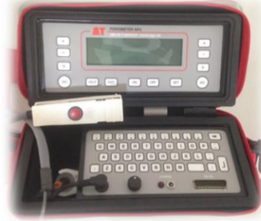
Şekil 3.7. Stoma iletkenliği ölçüm cihazı (AP4 Leaf Porometer).
