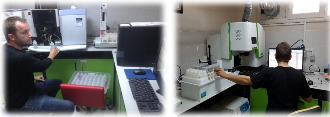
Şekil 3.5 Atomik Absorbsiyon Spektrometre ve Inductively Coupled Plasma (ICP) cihazlarının analizler için kullanımı.
