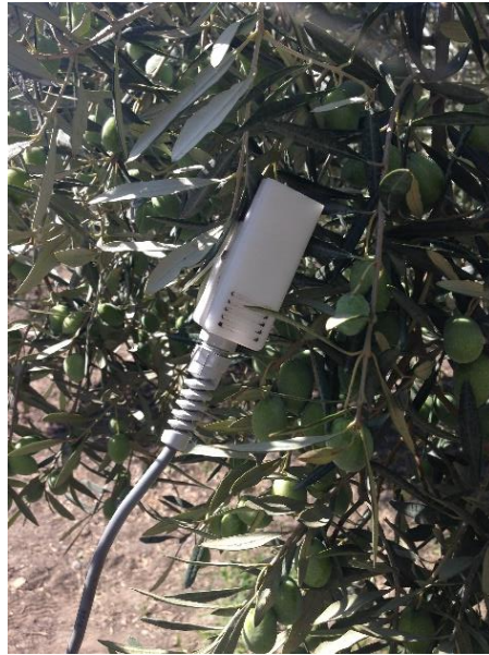
Şekil 3.9 Arařtırma alanında stoma iletkenliđi ölçümü
