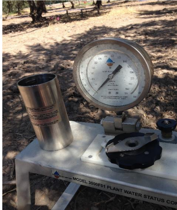
Şekil 3.7 Scholander tip basınç odası cihazı
