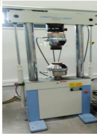
Şekil 4.7. Basma testinin gerçekleştirildiği basma cihazı SHIMADZU EHF-EV200k2-040-0A.
