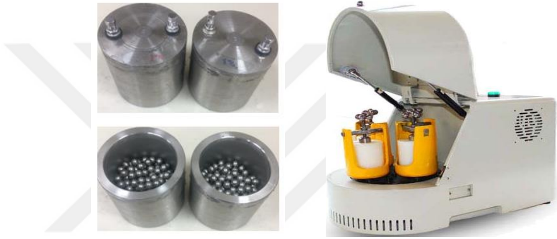
Şekil 4.5. Planet bilyalı öğütme cihazı ve 304L paslanmaz çelik kap.
