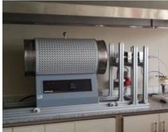
Şekil 4.6. Sinterleme işleminin gerçekleştirildiği Ar atmosfer korumalı tüp fırın.
