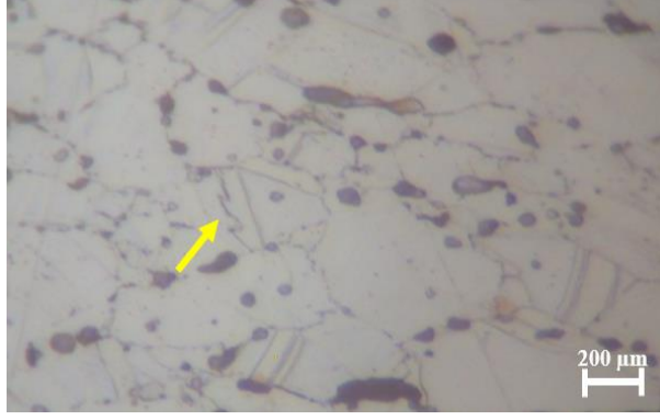
Şekil 4.27. Ağırlıkça %2 ZrO 2 takviye içeren TRIP matris kompozitteki kıvrılmış ikiz sınırlarına ait optik mikroskop görüntüsü.
