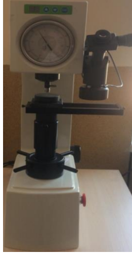
Şekil 4.8. Sertlik testinin gerçekleştirildiği Brinell sertlik cihazı.
