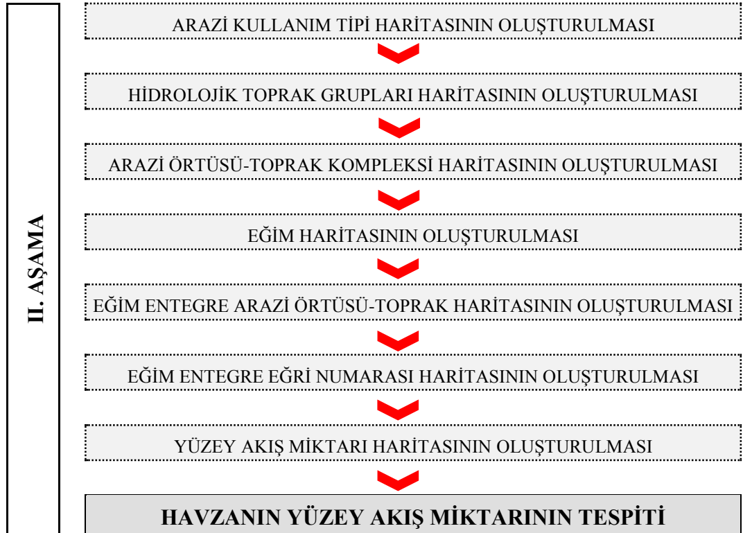
Şekil 3.15. Bornova Çayı Havzası yüzey akış miktarı tespiti akış şeması.
