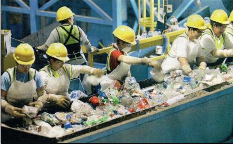
Şekil 2.10. Konveyör band üzerinde renklerine göre el ile ayırma işlemi.
