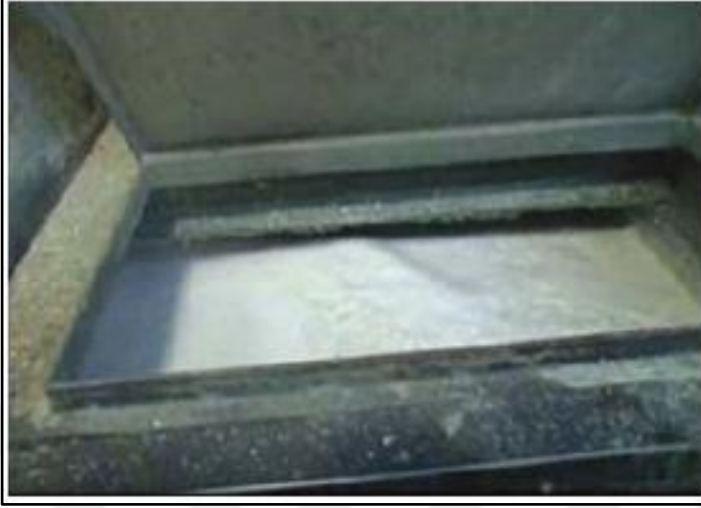
Şekil 2.12. Yoğunluk farkına göre ayırım: Yüzdürme- Batırma banyosu (Telli, 2011).
