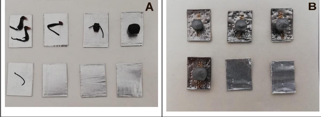
Şekil 3.1.2. SEM için kullanılacak A) kaplanmamış, etüvde bekletilecek B) kaplanmış örnekler (orijinal).
