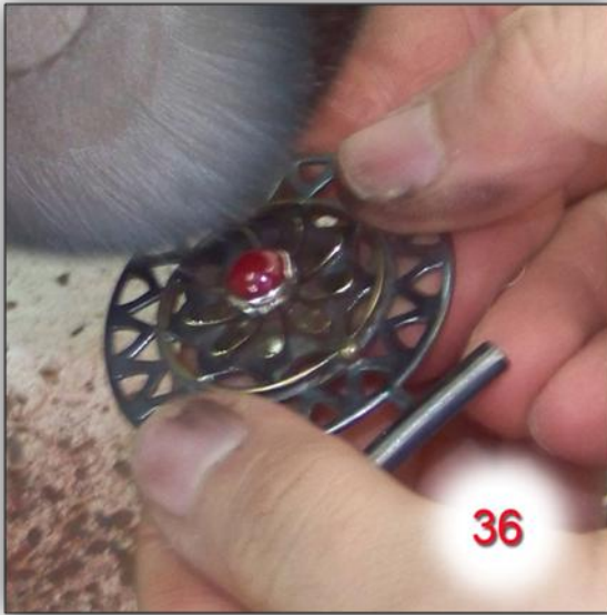
Şekil 129-Uygulama Çalışması Cila İşlemi
