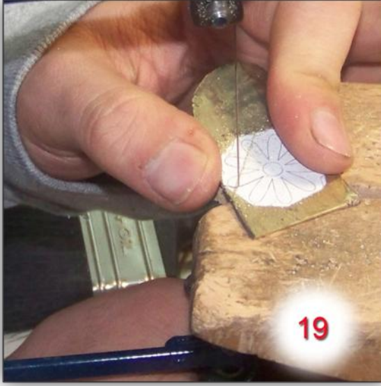
Şekil 112-Uygulama Çalışması Kıl Testeresi İle Kesim İşlemi
