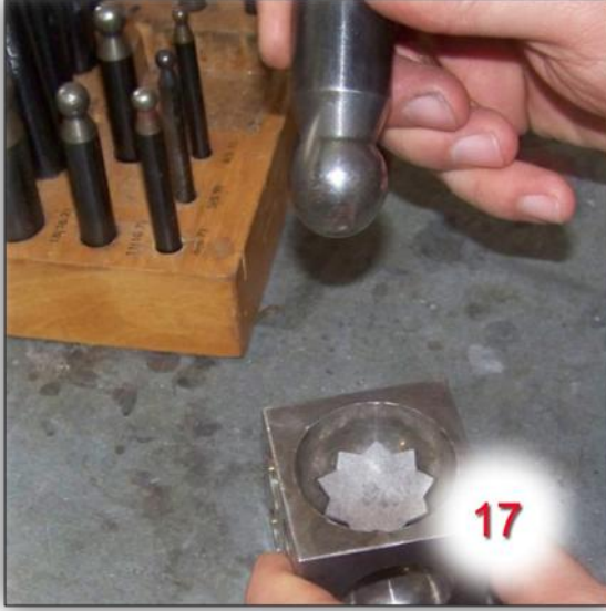
Şekil 110-Uygulama Çalışması Kabartma İşlemi
