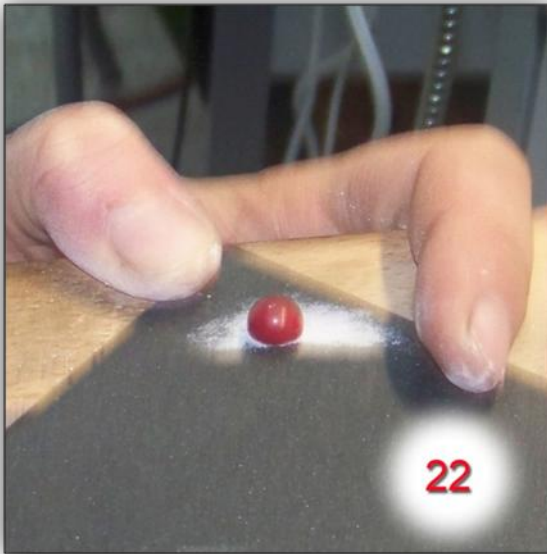
Şekil 115-Uygulama Çalışması Mercan Zımparalama İşlemi
