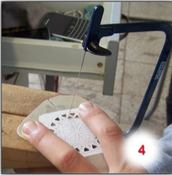
Şekil 97-Uygulama Çalışması Kıl Testeresi Kullanma İşlemi
