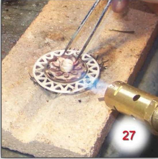
Şekil 120-Uygulama Çalışması Kaynak İşlemi
