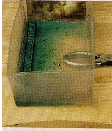
Şekil 38-Asit İndirme Metalin Asit İçerisinde Çözülmesi
