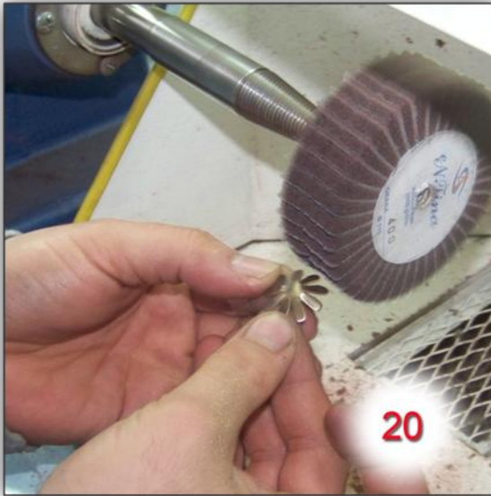
Şekil 113-Uygulama Çalışması Zımpara İşlemi
