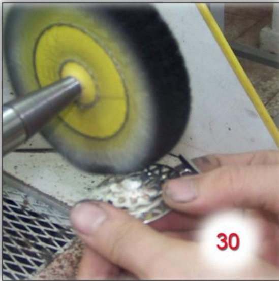
Şekil 123-Uygulama Çalışması Cila İşlemi
