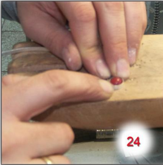
Şekil 117-Uygulama Çalışması Kuşak Yuva Yapımı
