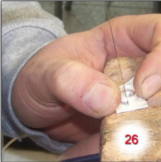
Şekil 119-Uygulama Çalışması Kuşak Yuva Yapımı Testere Kesimi
