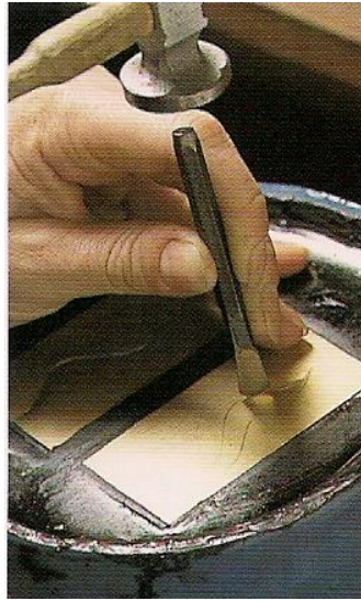
Şekil 23-Kabartma Örneği Çelik Kalemle Kontürlerin Belirlenmesi İşlemi
