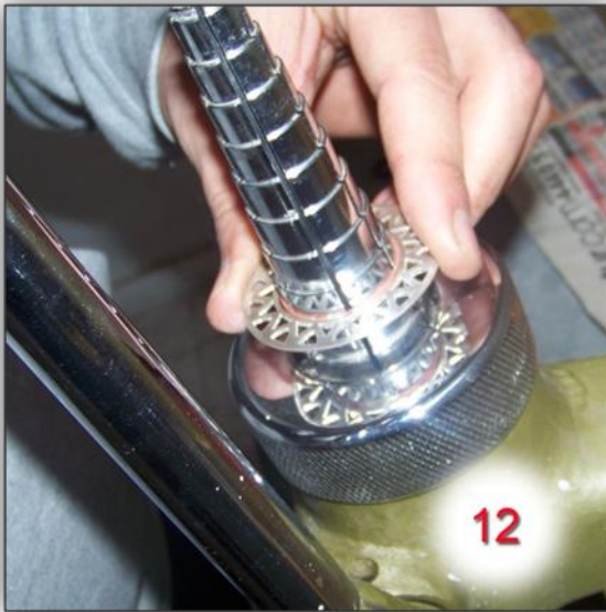
Şekil 105-Uygulama Çalışması Yüzük Boyu Ayarlama Makinesi Kullanımı
