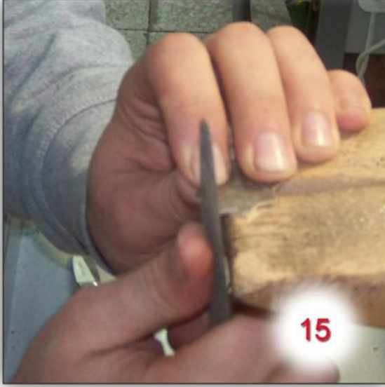
Şekil 108-Uygulama Çalışması Tesviye İşlemi
