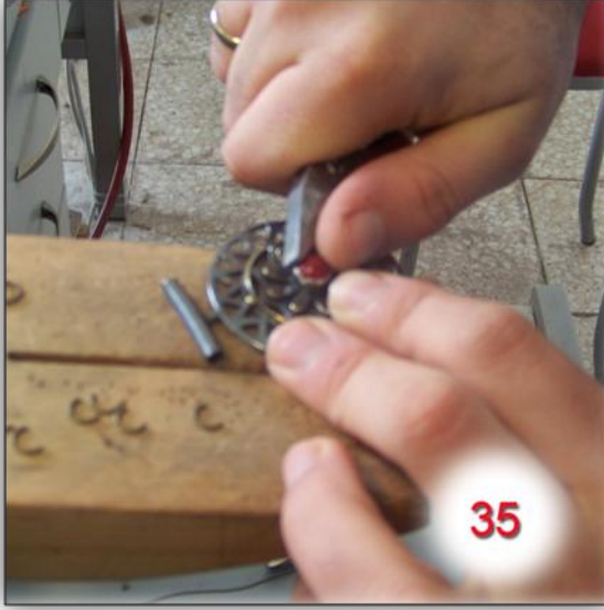
Şekil 128-Uygulama Çalışması Taş Sıvama İşlemi
