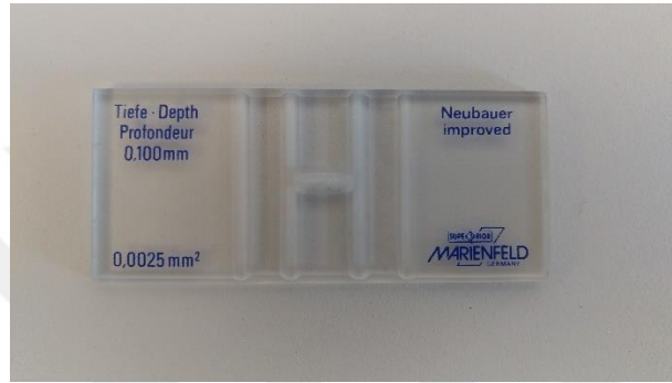
Şekil 3.1. Hücrelerin günlük sayımlarının yapıldığı hemositometre lamı
