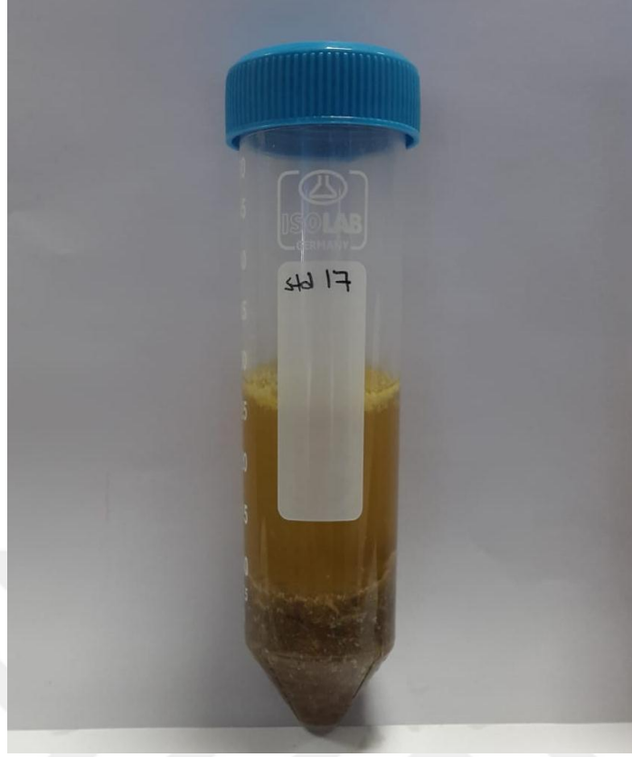
Şekil 3.2 Enzim destekli sulu ekstraksiyon yöntemi ile yağ eldesinde santrifüj sonrası fazların görünümü
