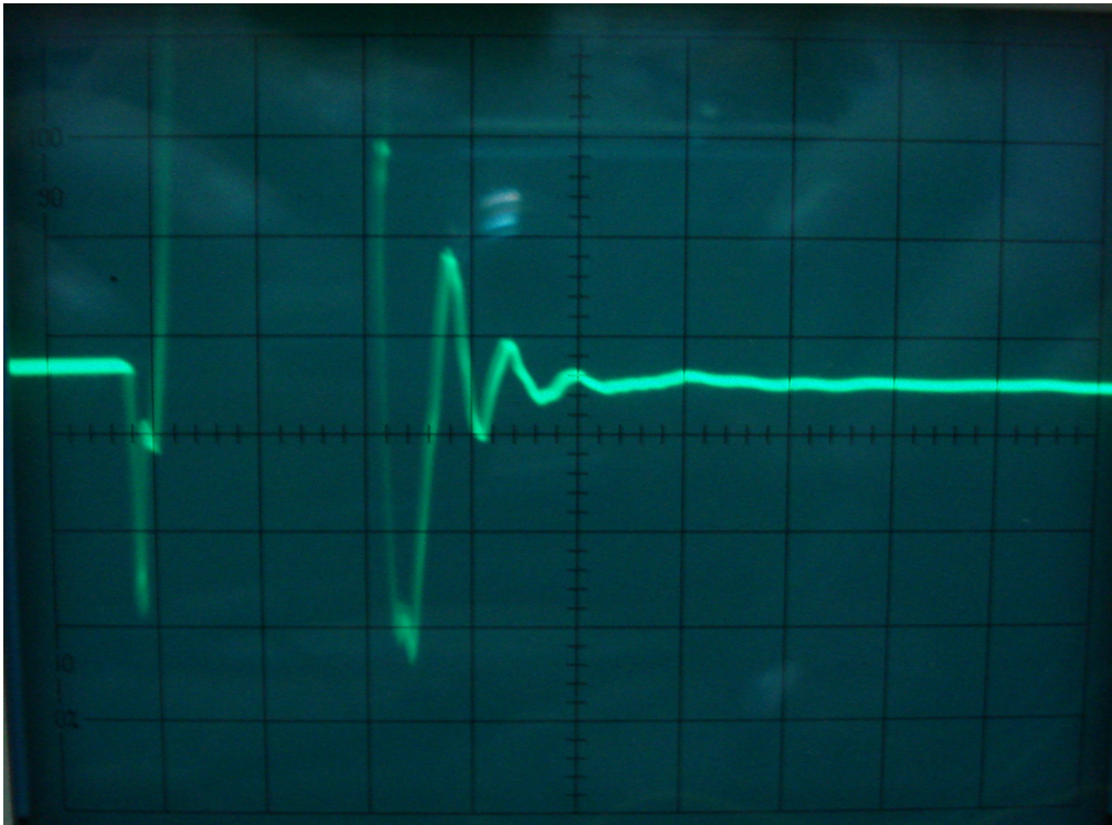
Resim 6.3. Dönüştürücü impuls cevabı (time/div: 0,2 \mu s volt/div: 50 mV)
