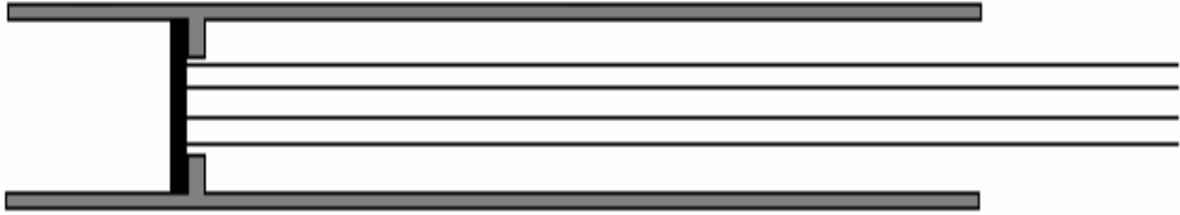
Şekil 6.4. Elektrotları yapıştırılan kristalin fiber boru içerisine yerleştirilmesi
