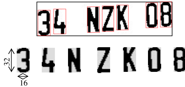
Şekil 3.11. Plakadan kopartılan karakterlerin boyutlarının eşitlenmesi (16x32 piksel)
