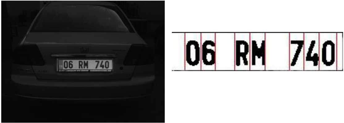
Resim 2.3. Plaka üzerindeki harfler arasında boşluk takibi
