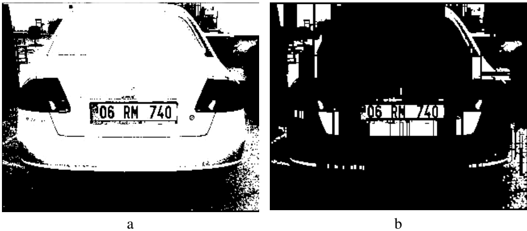
Resim 2.1. Kapalı dörtgenler yatay/dikey çizgiler yönteminin uygulaması, a. Siyah – beyaz forma dönüştürülmüş resim, b. Kapalı dörtgenler yatay/dikey çizgiler yöntemi uygulanmış resim
