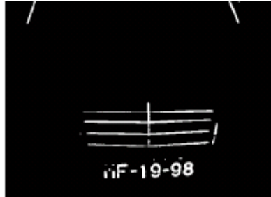
Resim 2.2. Açılış ve Kapanış işlemlerinin araç resmine uygulanması a. Orijinal gri ölçekli girdi görüntüsü, b. Açılıştan sonraki işlem görmüş görüntü, c. Çıkarımdan (a' dan b) sonraki işlem görmüş görüntü.
