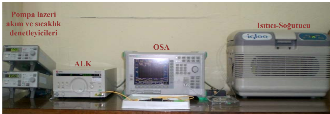
Resim 5.2. Sıcaklığa bağımlı kazanç spektrumu pratik ölçüm düzeneği
