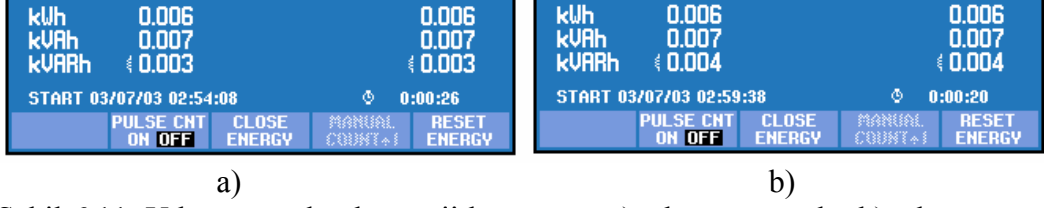
Şekil 6.11. Yıkama modunda enerji harcaması a) sıkma yönünde b) sıkma yönünün tersine
