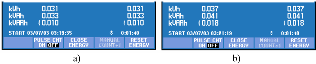
Şekil 6.13. ARM sıkma modunda çalışırken enerji ölçümleri a) başlangıç anı enerji harcaması b) tam hız bölgesi enerji harcaması
