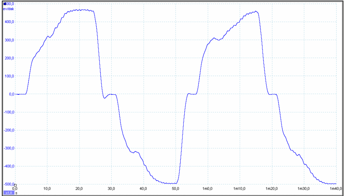
Şekil 6.22. Yıkama modunda aç kapa denetleyicili ARM hız grafiği
