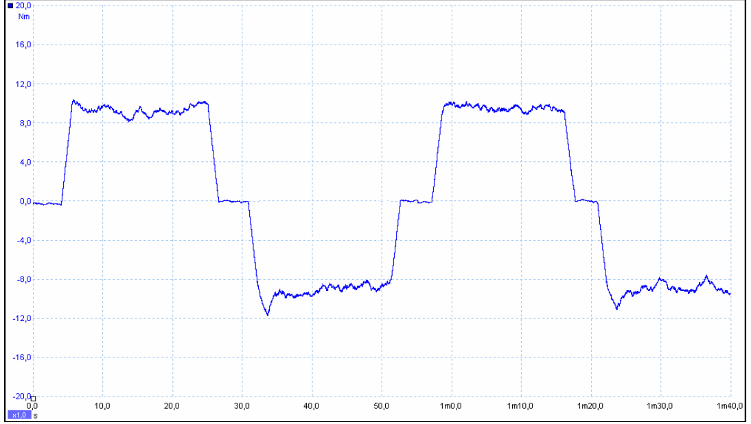
Şekil 6.15. Yıkama modunda sıkma yönü ve sıkma yönünün tersine tork
