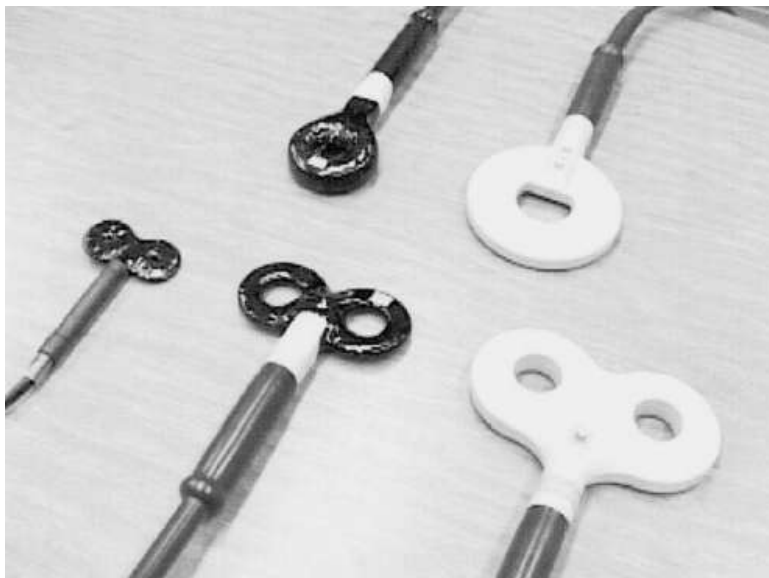
Şekil 2. 16. Çeşitli şekillerde üretilmiş uyarım bobinleri [5]
