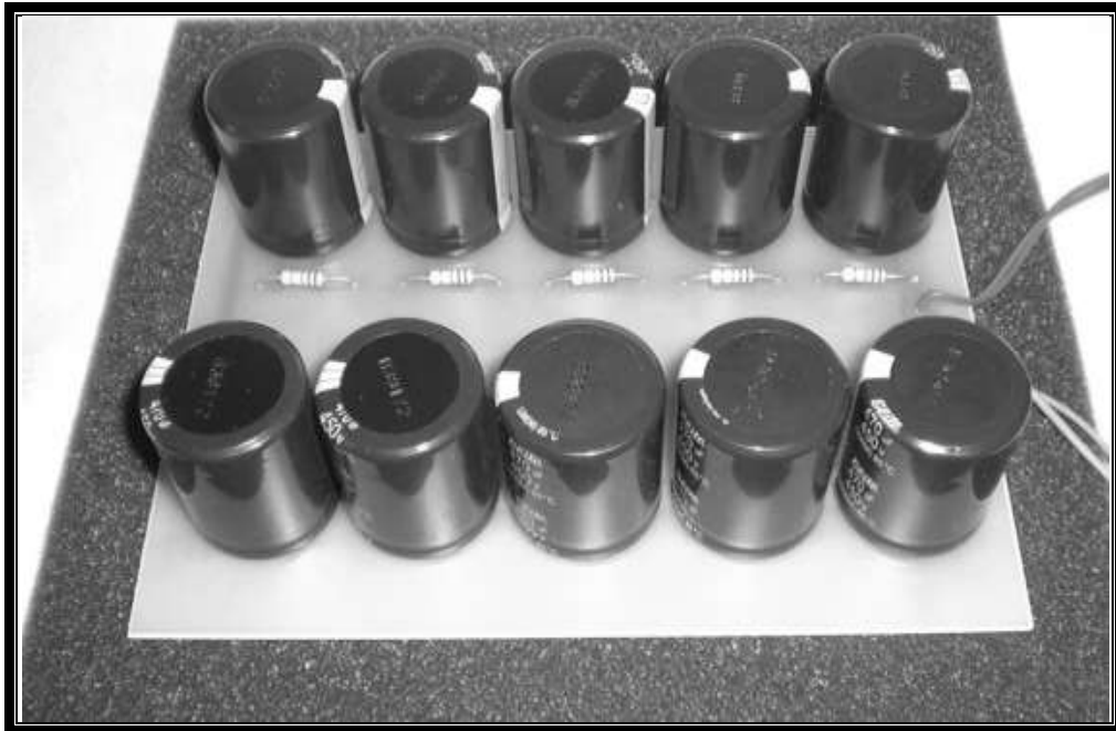
Resim 3. 2. Kondansatör birimi kartı
