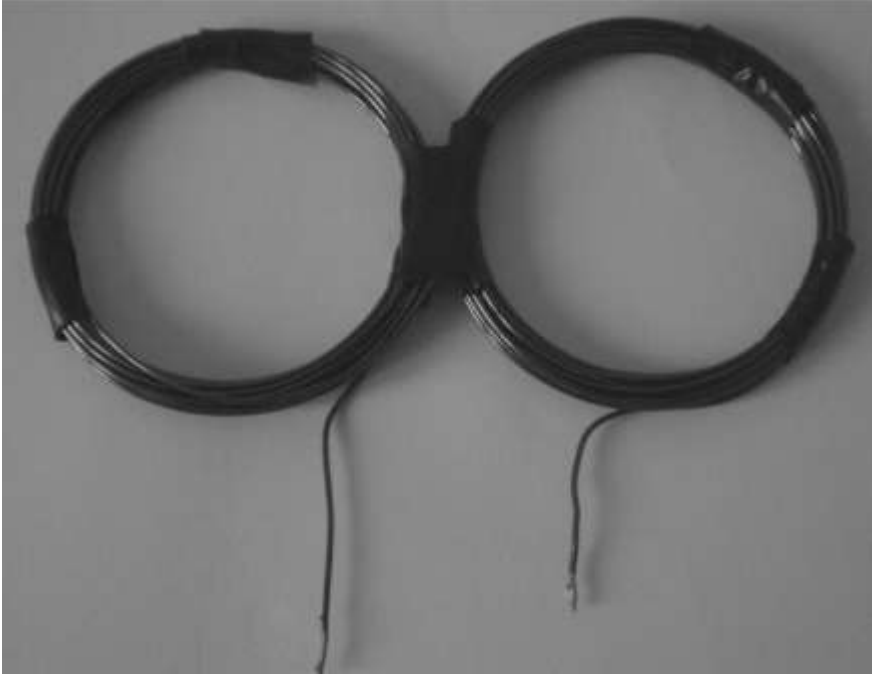
Resim 3. 4. Sekiz şeklinde sarılan uyarım bobini
