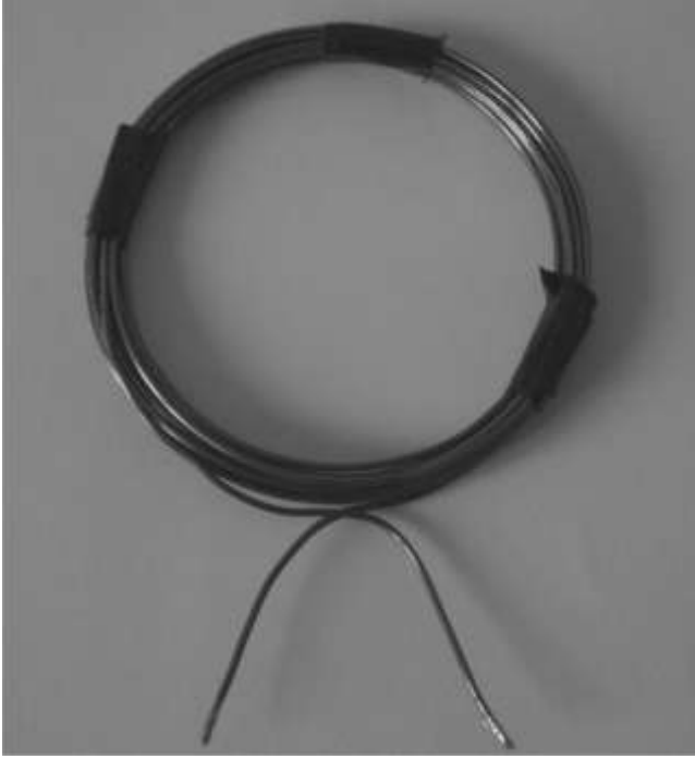
Resim 3. 3. Daire şeklinde sarılan uyarım bobini
