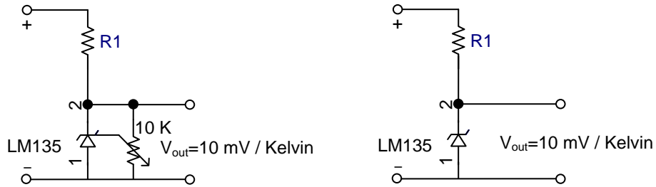
Şekil 3.2. Entegre devre sıcaklık algılayıcısının devreye bağlantısı
