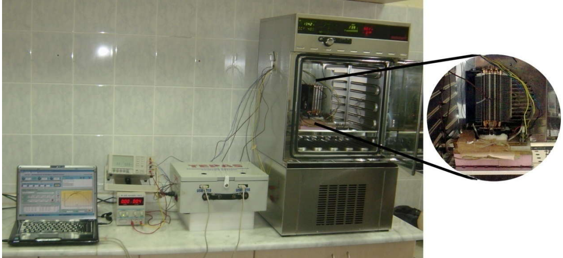
Resim 6.1. TE soğutma sistemi performans analizinin TEPAS ile yapılmasına yönelik deney düzeneği
