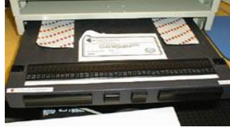
Resim 3. 4 Brail Alfesini kullanarak çıktı verebilen cihaz
