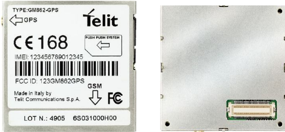
Şekil 4.2. GM862 modülün üstten ve alttan görünümü.
