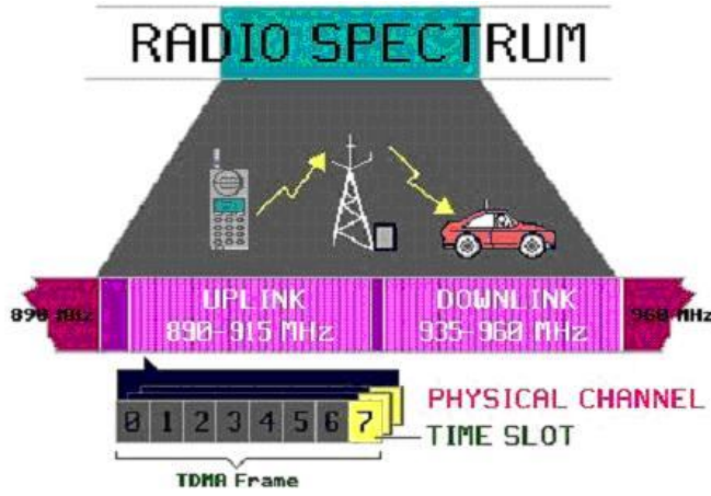
Şekil 3.8. GSM 900Mhz frekans kanalları.
