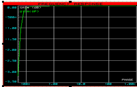
Resim 2.2. Sistemde kullanılan 3. derece yüksek geçiren filtrenin frekans eğrisi.
