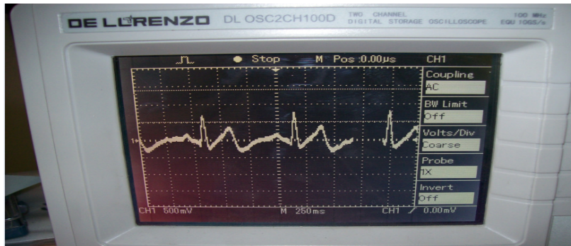
Resim 4.3. Osiloskopta görüntülenen EKG sinyali.
