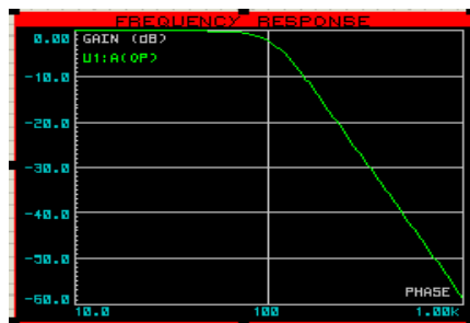
Resim 2.3. Sistemde kullanılan 3.derece alçak geçiren filtrenin frekans eğrisi.
