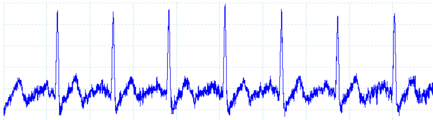
Resim 4.6. Sistemdeki analog devre çıkışının pcoscope görüntüsü.
