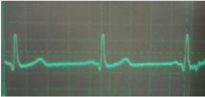
Resim 5.1. EKG işaretinin sayısal osilaskoptaki görüntüsü
