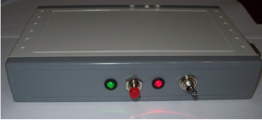
Resim 1.2. On/off anahtarı açık iken LED'lerin durumu
